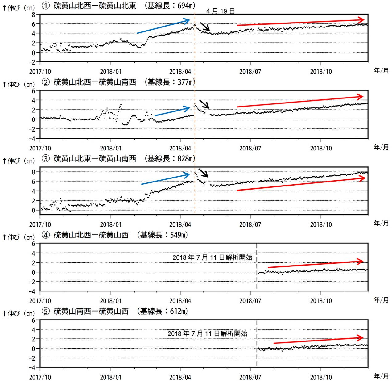
図 9 霧島山（えびの高原（硫黄山）周辺） GNSS 連続観測による基線長変化
