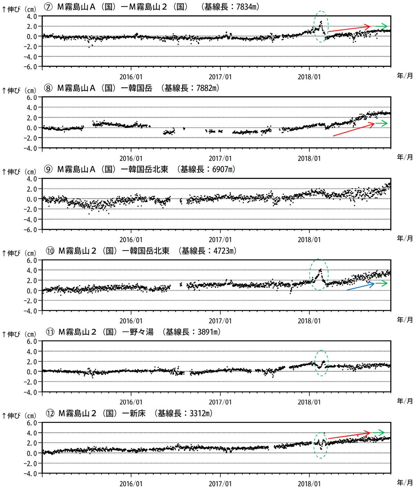
図 11-2 霧島山（えびの高原（硫黄山）周辺） GNSS 連続観測による基線長変化
