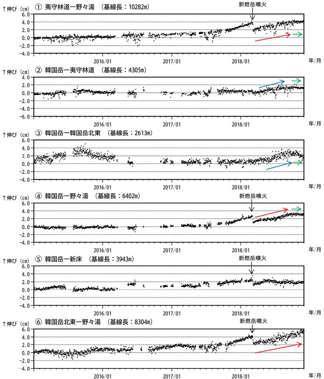
図 11-1 霧島山（えびの高原（硫黄山）周辺） GNSS 連続観測による基線長変化
