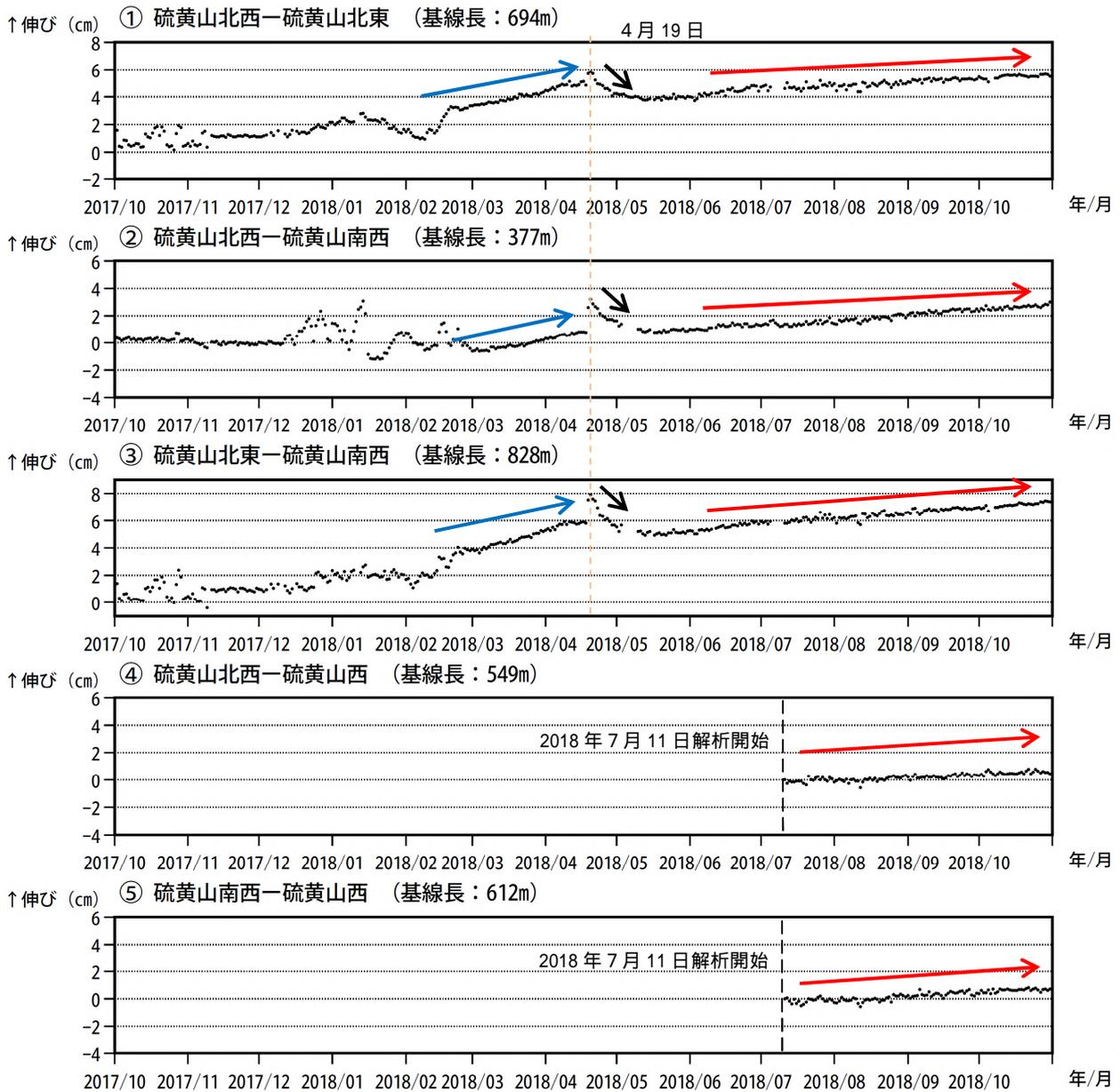
図 14 霧島山（えびの高原（硫黄山）周辺） GNSS 連続観測による基線長変化
