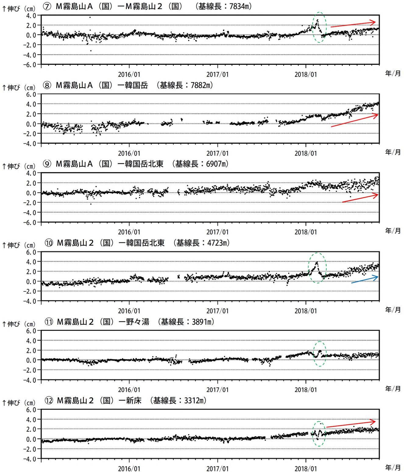
図 16-2 霧島山(えびの高原(硫黄山)周辺) GNSS 連続観測による基線長変化 (2015年1月~2018年10月)
