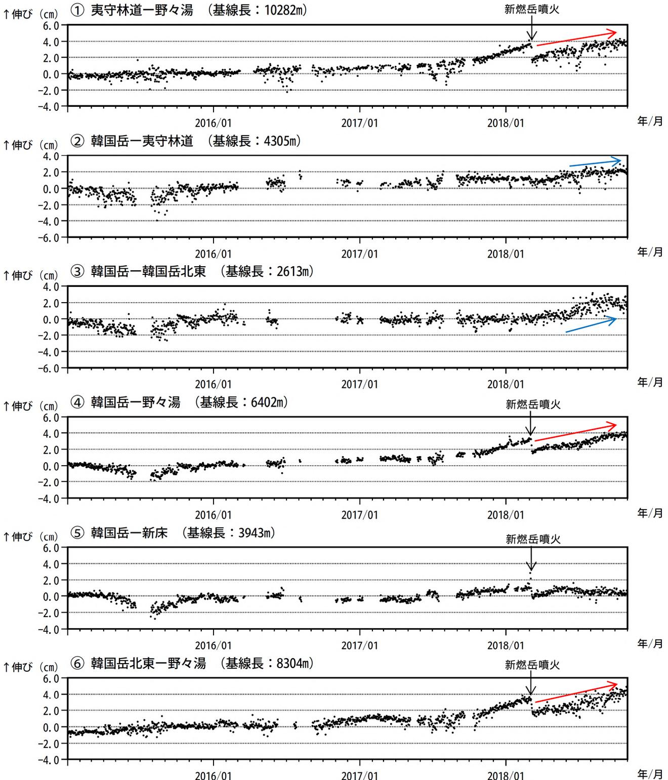
図 16-1 霧島山（えびの高原（硫黄山）周辺） GNSS 連続観測による基線長変化
