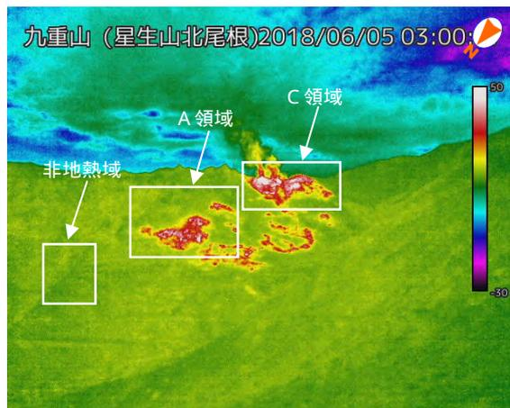
図2-1 九重山 地熱域の状況(6月5日、星生山北尾根赤外熱映像装置による)
