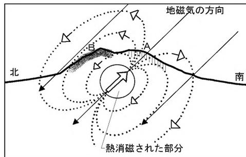
図7 熱消磁に伴う全磁力変化のモデル
