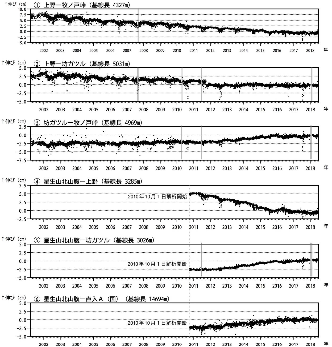
図8 九重山 GNSS連続観測による基線長変化(2001年3月~2018年6月)
