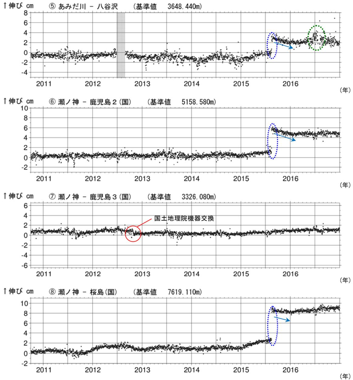
図 8-2 桜島 GNSS 連続観測による基線長変化 (2010 年 10 月～2016 年 12 月)
