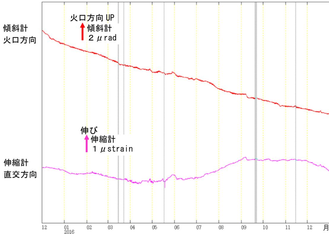
図 7 桜島 有村観測坑道の傾斜計及び伸縮計の変化（2015 年 12 月 1 日～2016 年 12 月 31 日）
