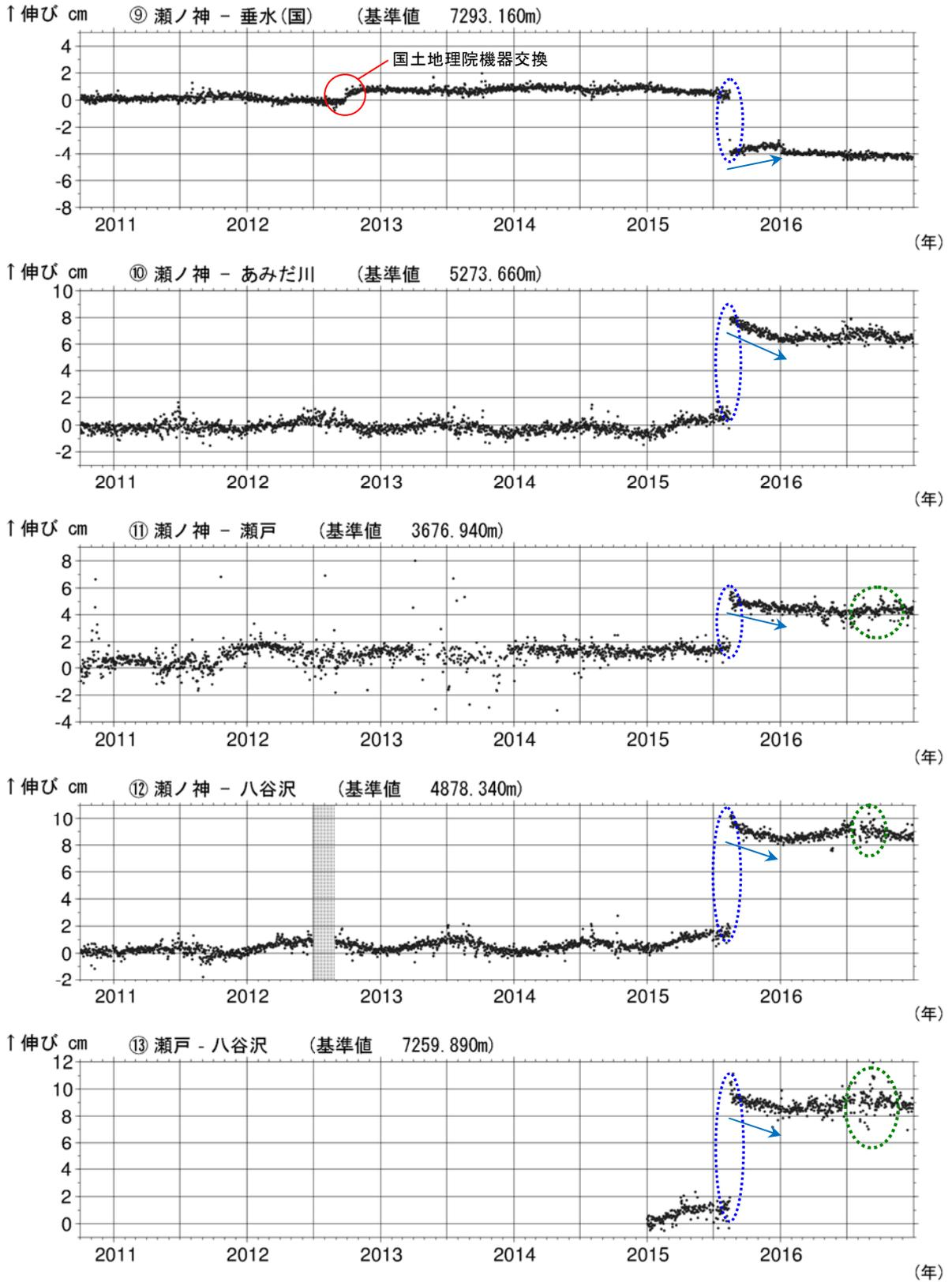
図 8-3 桜島 GNSS 連続観測による基線長変化（2010 年 10 月～2016 年 12 月）
