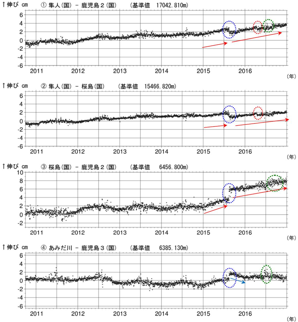
図 8-1 桜島 GNSS 連続観測による基線長変化（2010 年 10 月～2016 年 12 月）
