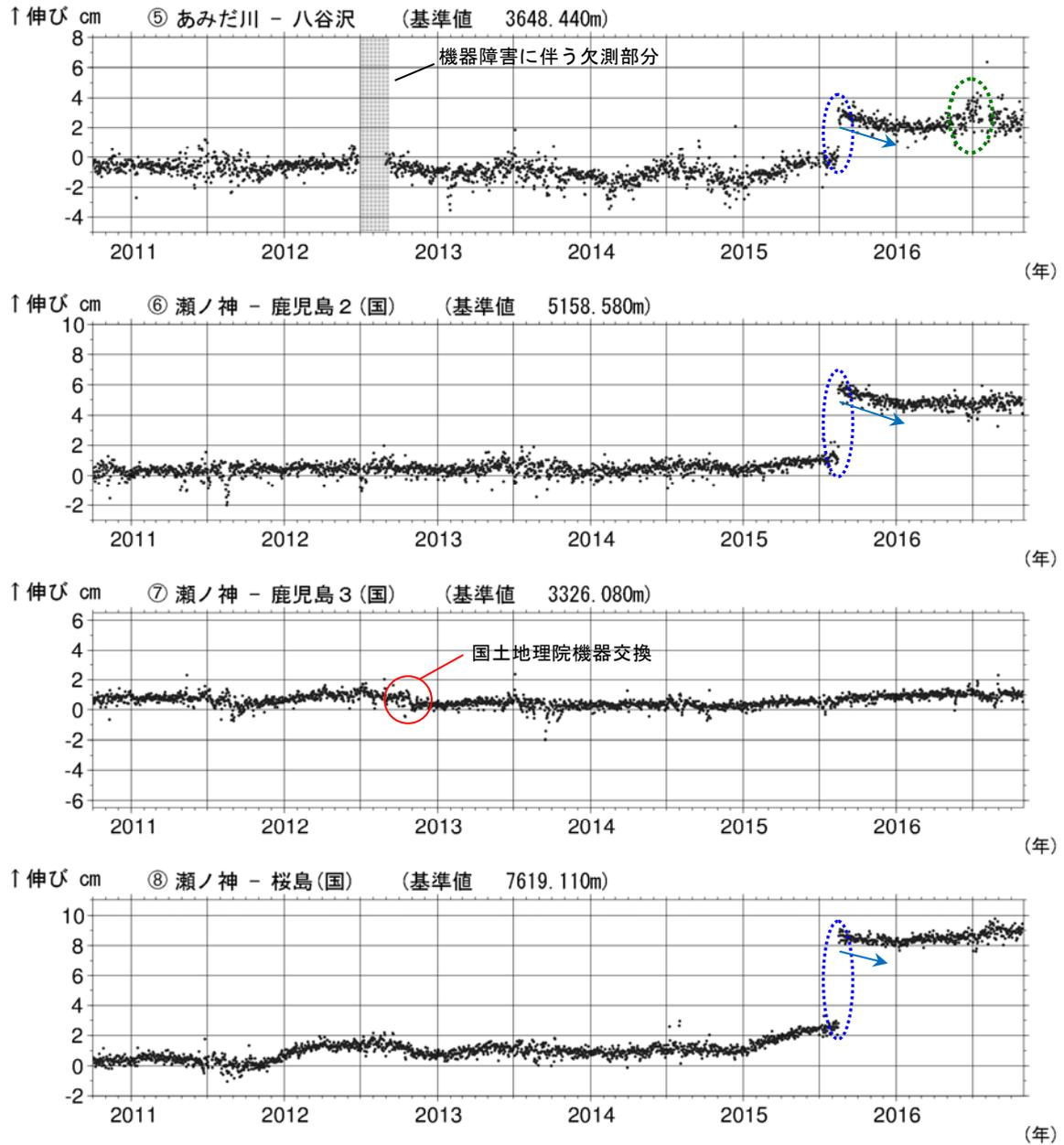
図 8-2 桜島 GNSS 連続観測による基線長変化（2010 年 10 月～2016 年 10 月）
