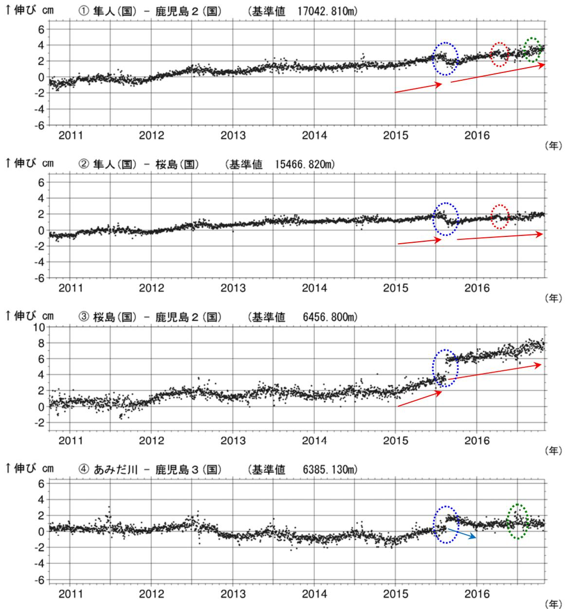
図 8-1 桜島 GNSS 連続観測による基線長変化（2010 年 10 月～2016 年 10 月）
