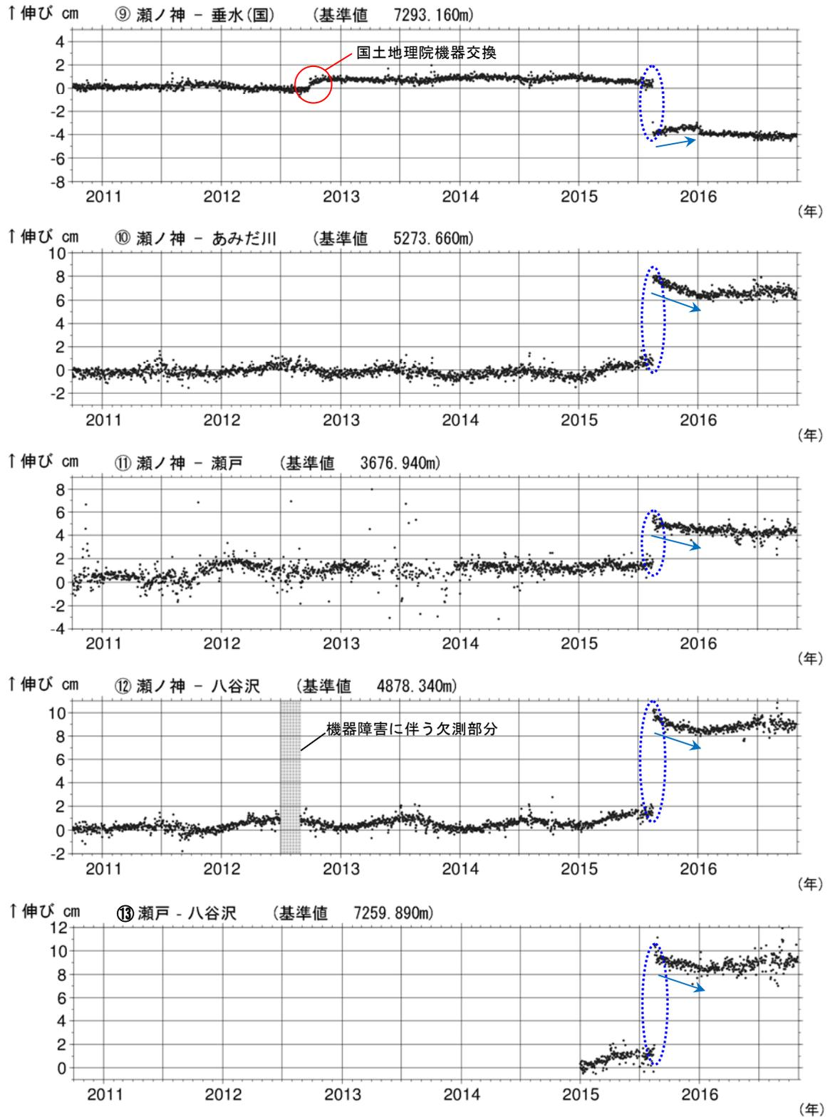
図 8-3 桜島 GNSS 連続観測による基線長変化（2010 年 10 月～2016 年 10 月）
