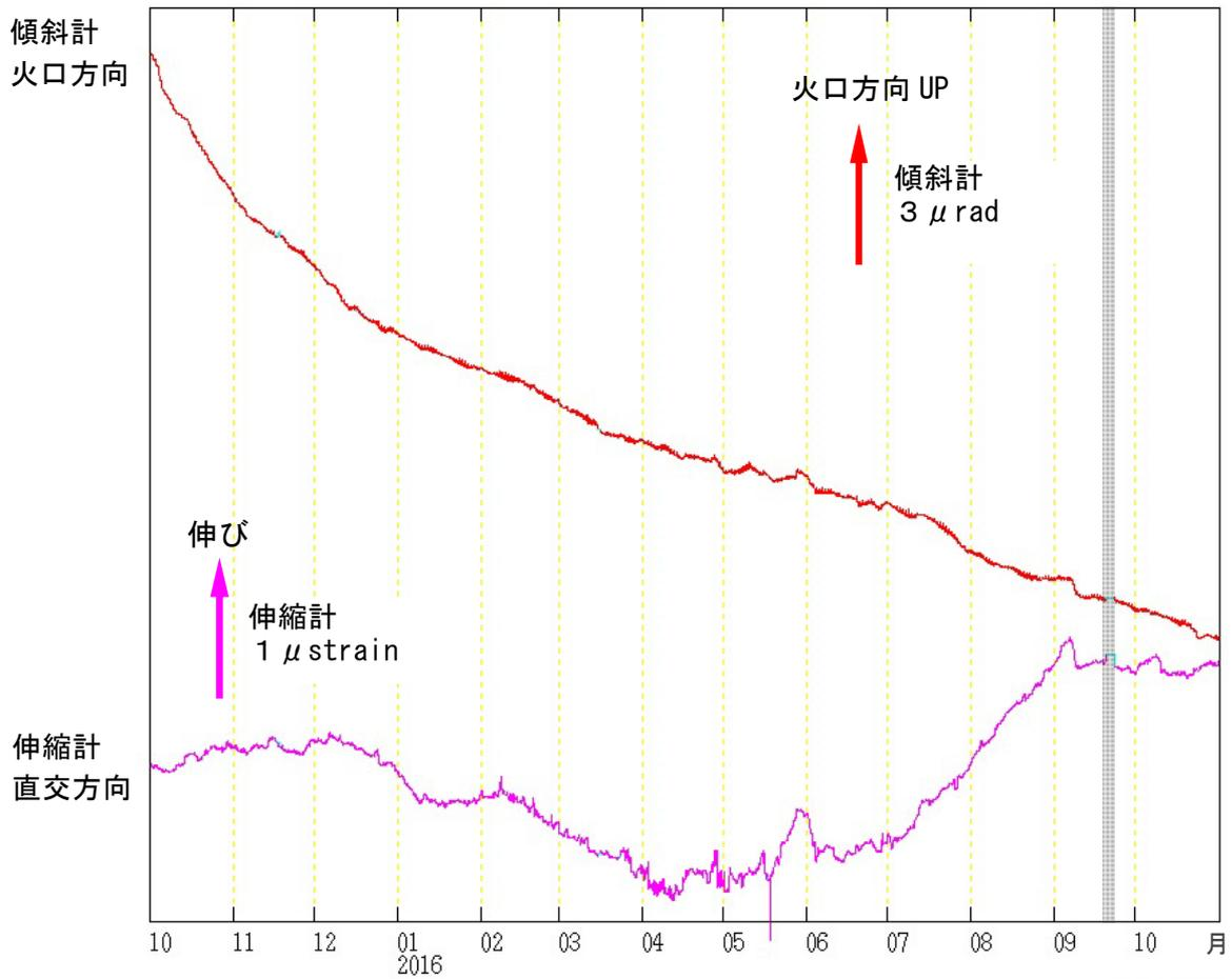
図 7 桜島 有村観測坑道の傾斜計及び伸縮計の変化（2015 年 10 月 1 日～2016 年 10 月 31 日）
