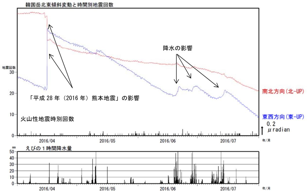
図 18 霧島山（えびの高原（硫黄山）周辺） 韓国岳北東傾斜計の傾斜変動と火山性地震の時間別回数（2016 年 4 月～2016 年 7 月）
