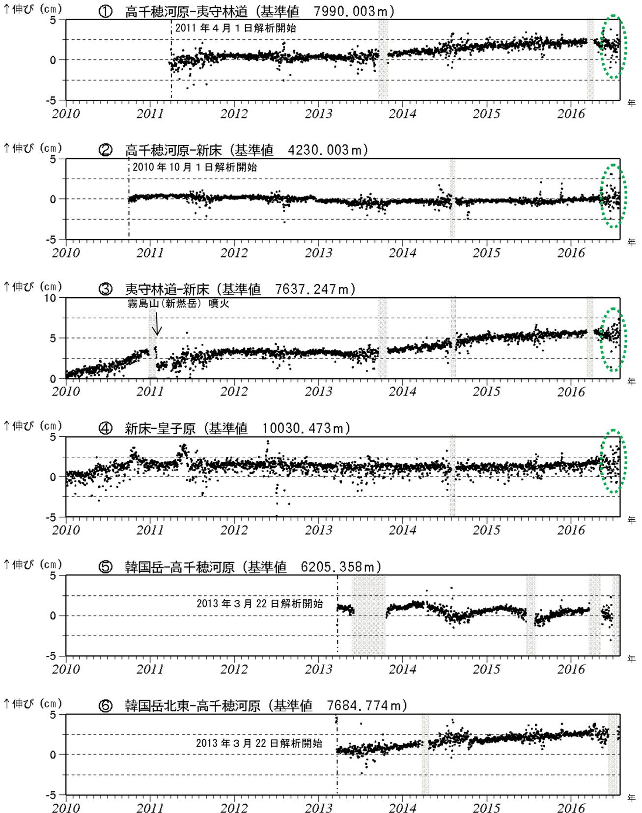
図 6-1 霧島山（新燃岳） GNSS 連続観測による基線長変化（2010 年 1 月～2016 年 7 月）
