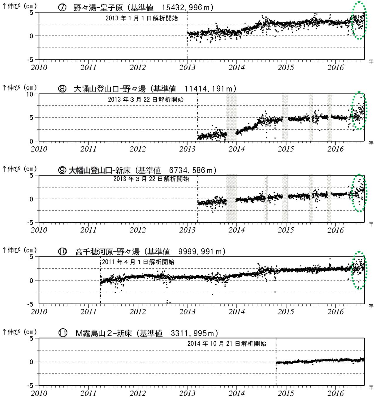
図 6-2 霧島山（新燃岳） GNSS 連続観測による基線長変化（2010 年 1 月～2016 年 7 月）
