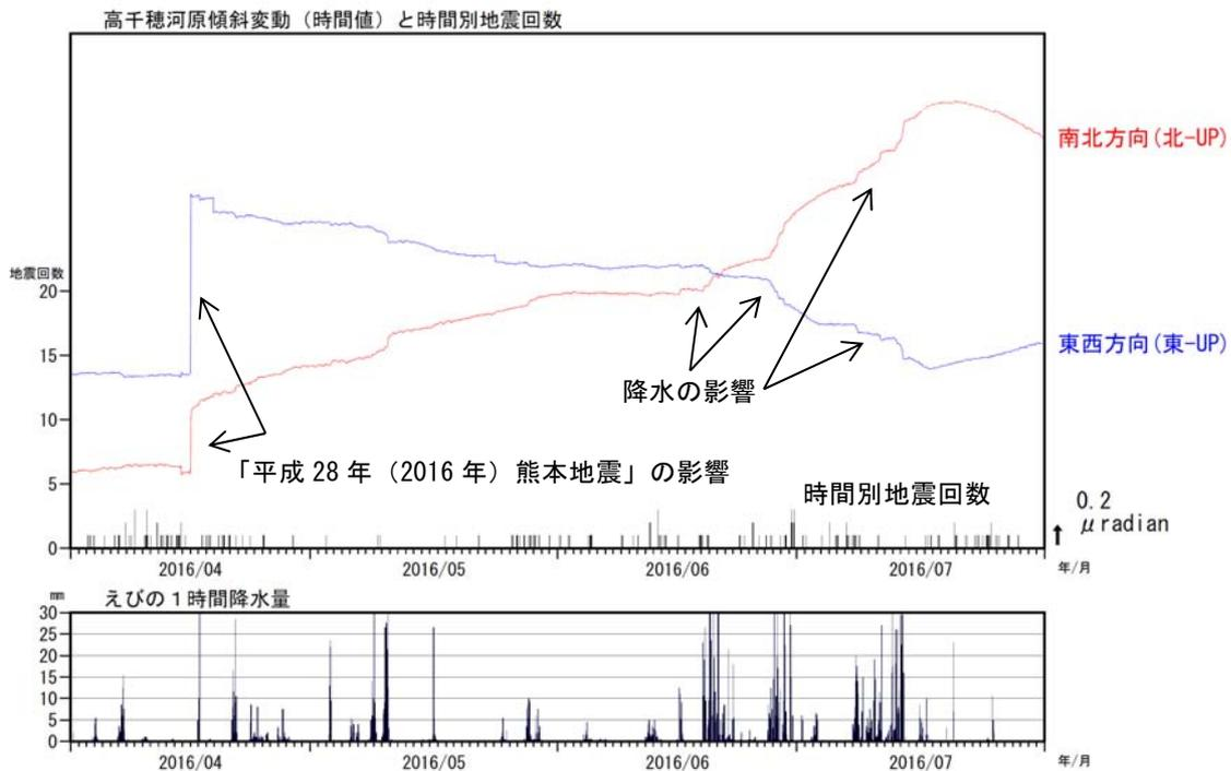
図4 霧島山（新燃岳） 高千穂河原傾斜計の傾斜変動と火山性地震の時間別回数（2016年4月～2016年7月）
