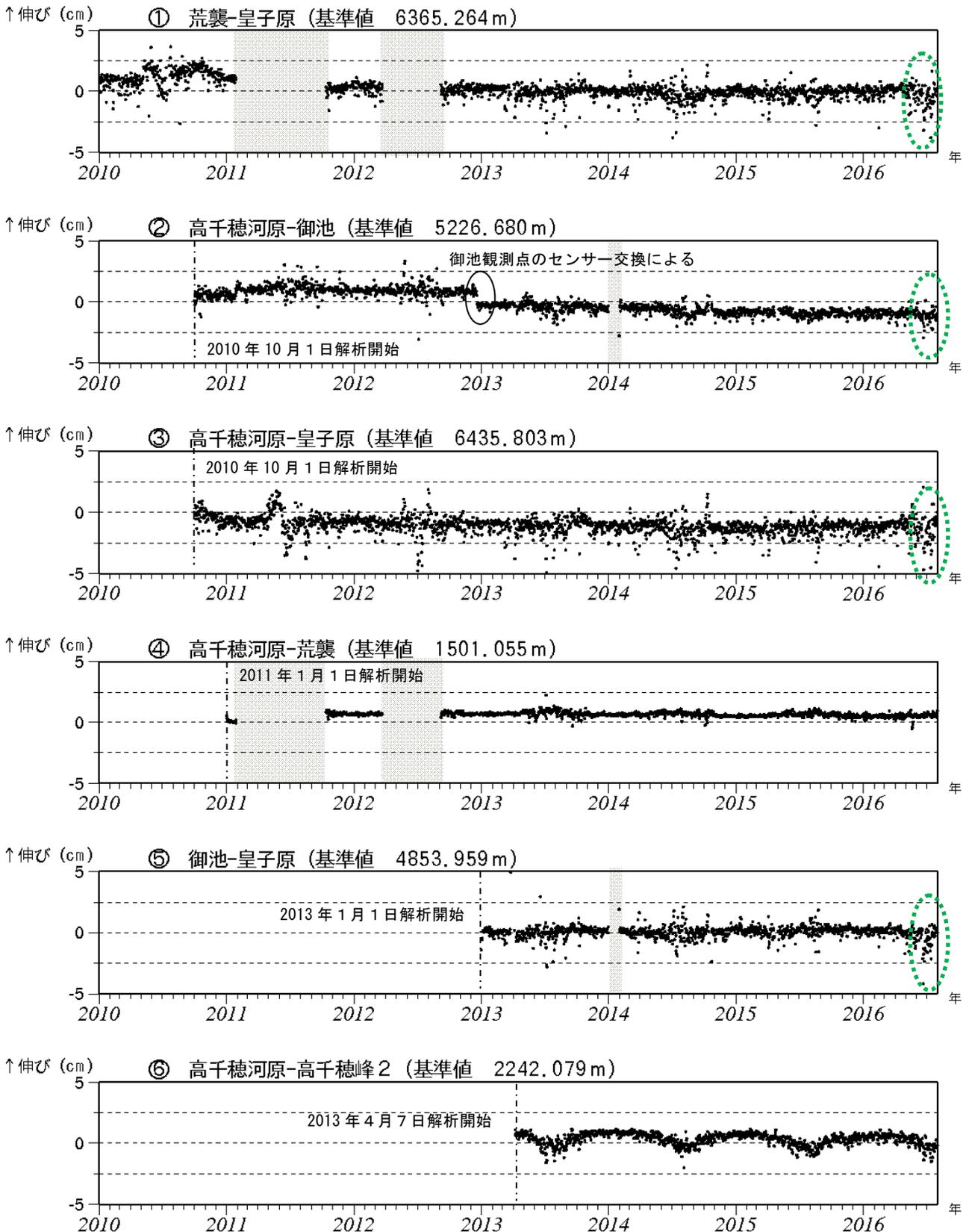
図 13 霧島山（御鉢） GNSS 連続観測による基線長変化（2010 年 1 月～2016 年 7 月）
