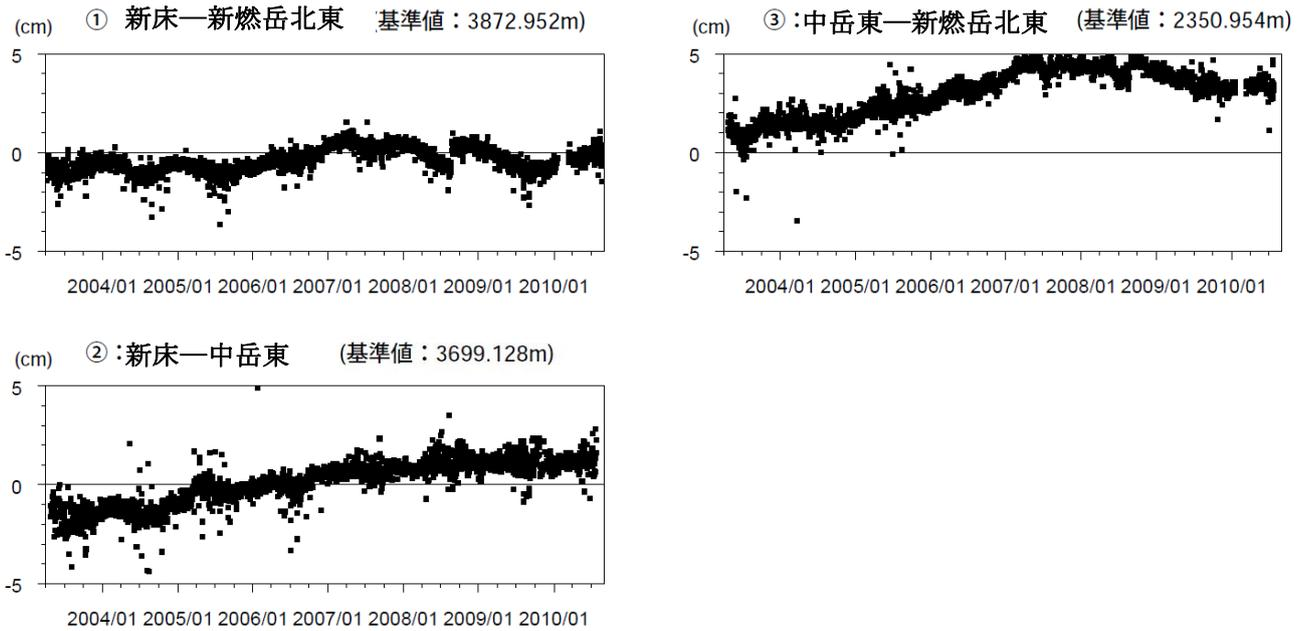
図4 霧島山（新燃岳） GPS 連続観測による基線長変化（2003 年 4 月～2010 年 8 月）
