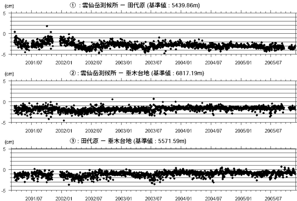
図4 GPSによる基線長変化(2001年3月20日～2005年11月30日)
