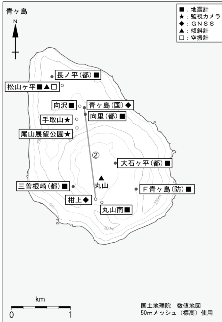
図4 青ヶ島 観測点配置図 GNSS 基線は図3の②に対応しています。
