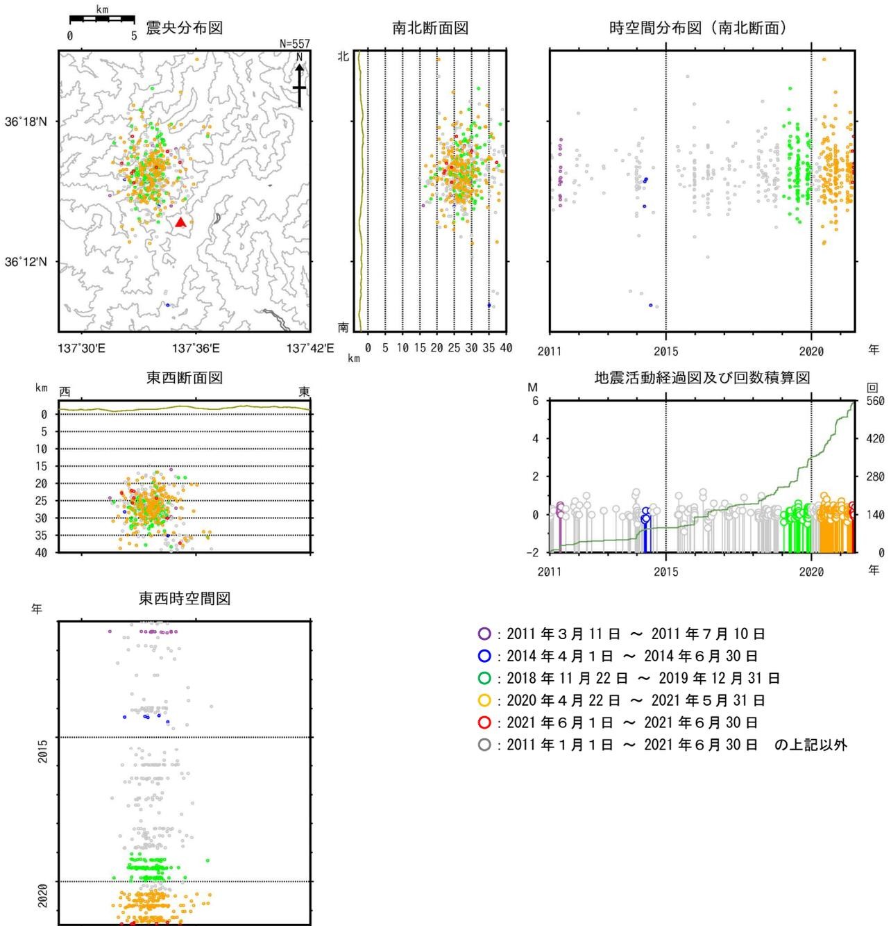
図3 焼岳 広域地震観測網による深部低周波地震の震源分布図（2011年1月1日～2021年6月30日）
