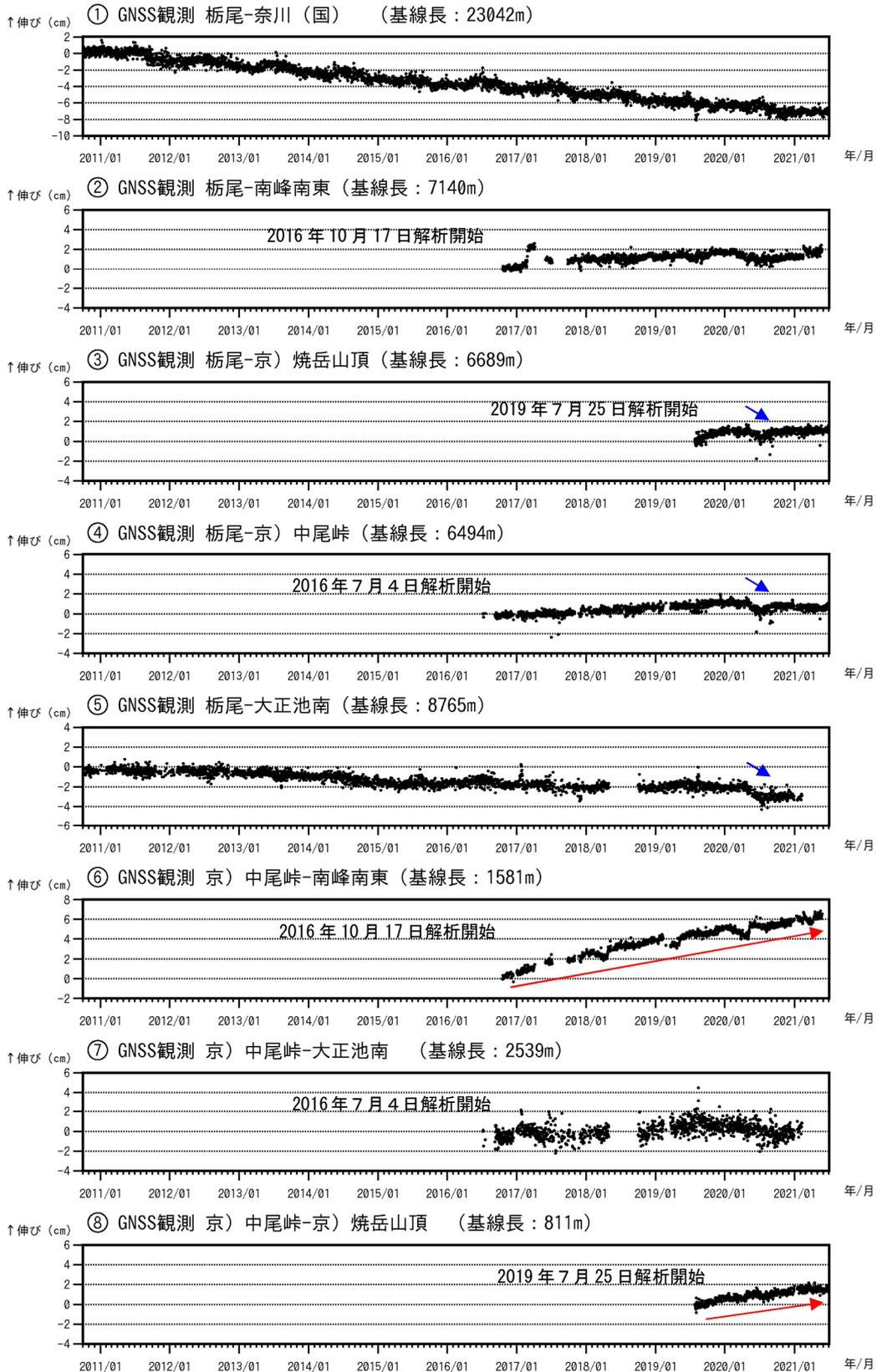
図7 焼岳 GNSS連続観測による基線長変化 (2010年10月1日~2021年6月30日)
