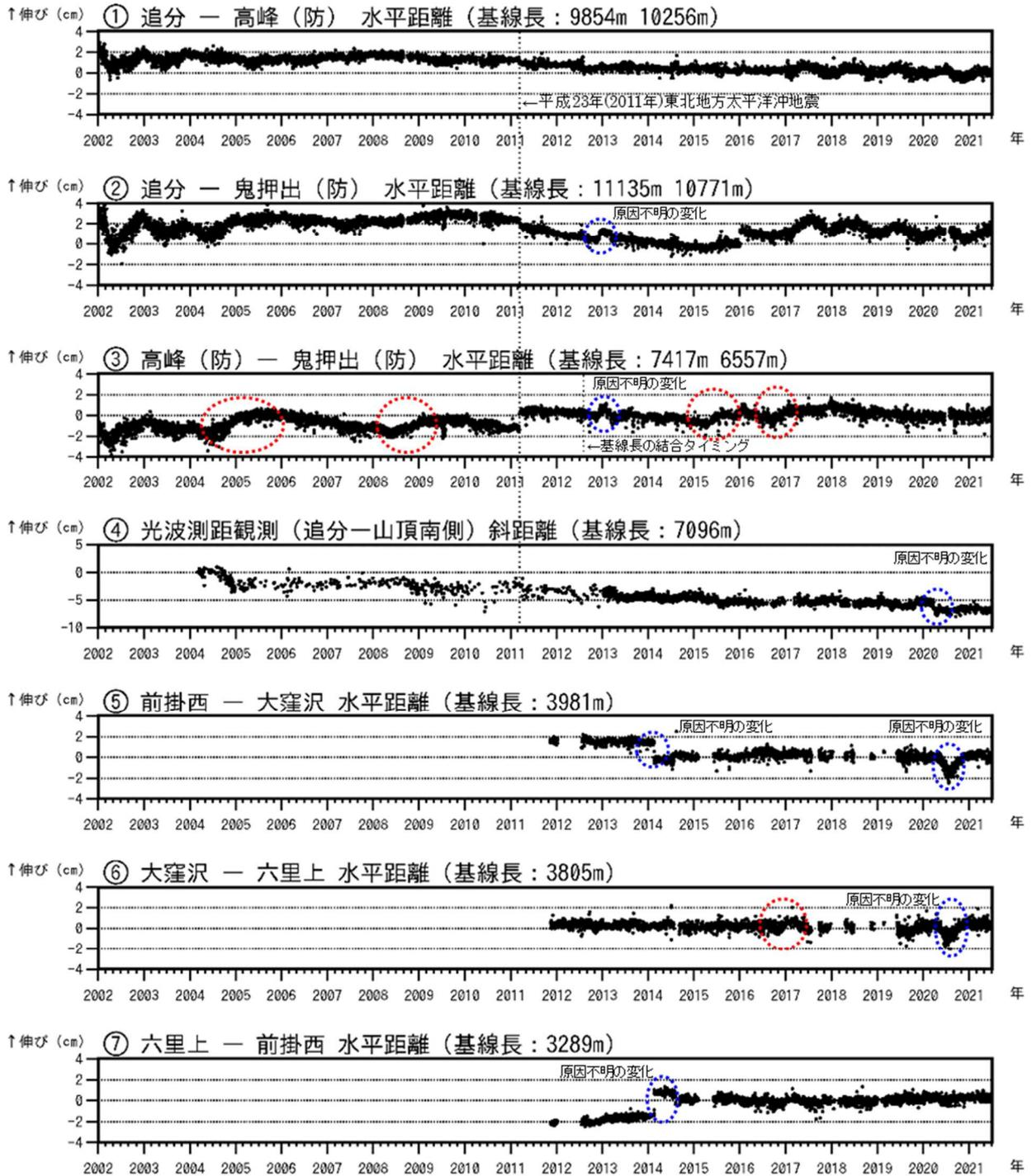
図6-1 浅間山 GNSS連続観測及び光波測距観測の結果(2002年1月1日~2021年6月30日)
