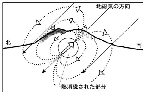
図11 熱消磁に伴う全磁力変化のモデル
