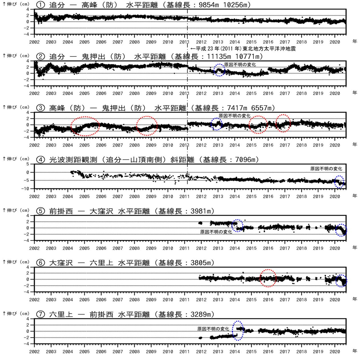
図7-1 浅間山 GNSS 連続観測及び光波測距観測の結果
