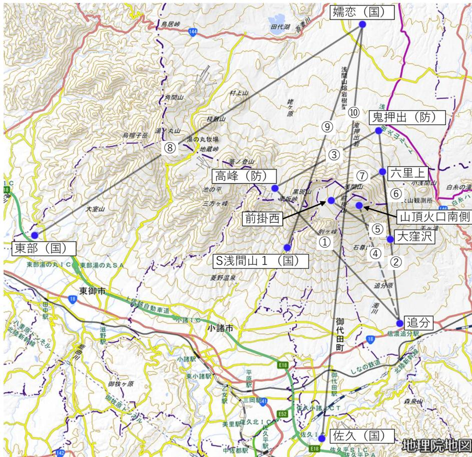
図8 浅間山 地殻変動連続観測点配置図
