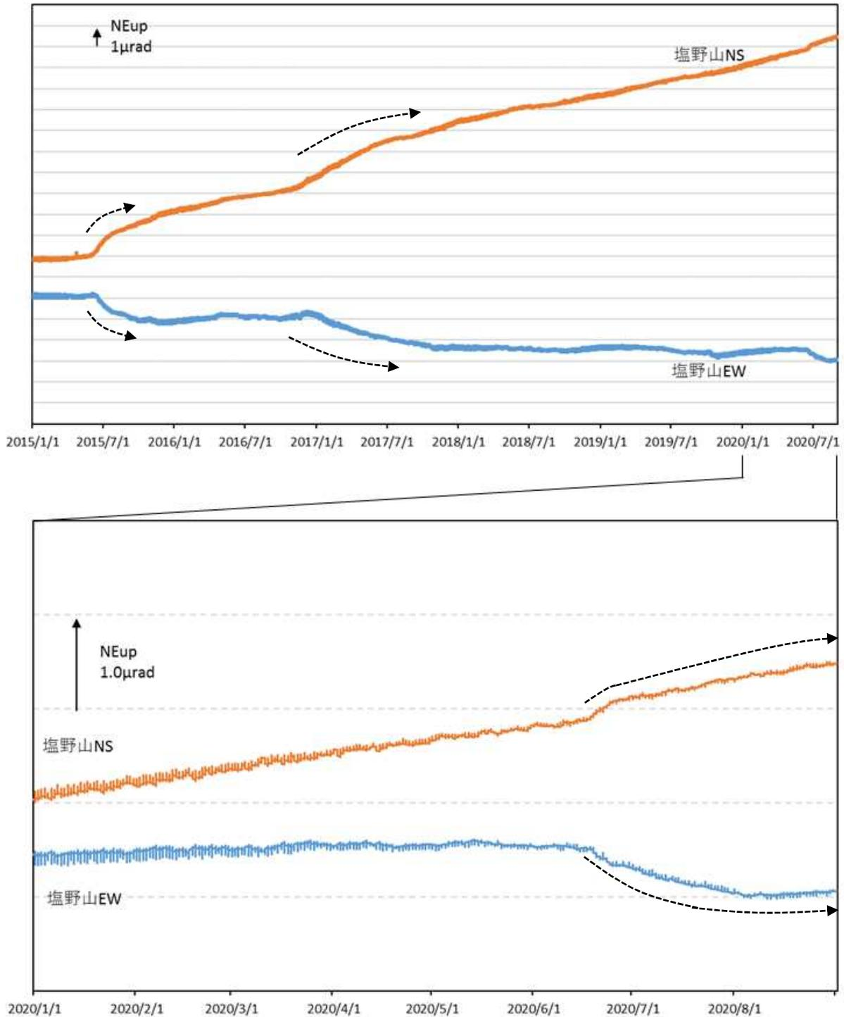
図9 浅間山 塩野山観測点における傾斜データ（2015年1月1日～2020年8月31日）
