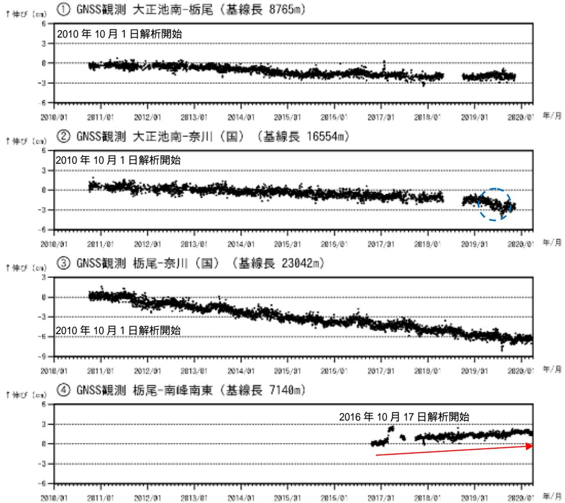
図6 焼岳 GNSS 連続観測による基線長変化 (2010年10月1日~2020年3月31日)
