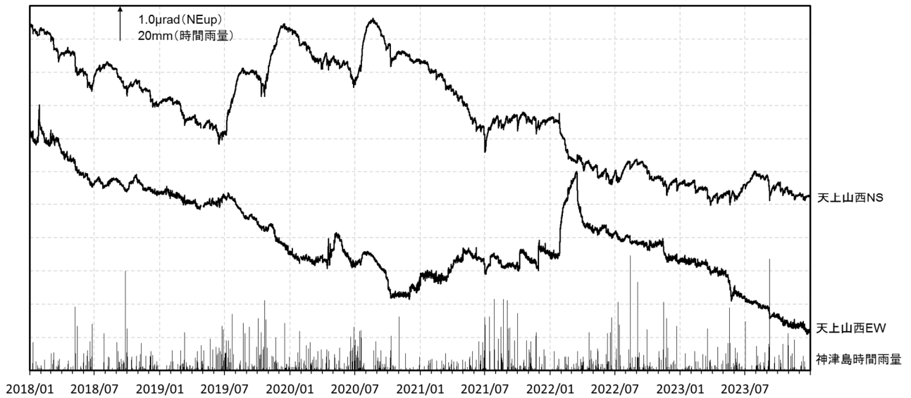
図4 神津島 天上山西観測点の傾斜変動（2018年1月1日～2023年12月31日） 地震等による一部のステップを除去しています。図中の空白部分は欠測を示します。 ・火山活動によるとみられる変動は認められませんでした。
