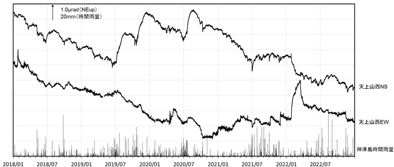
図4 神津島 天上山西観測点の傾斜変動（2018年1月1日～2022年12月31日） 地震等による一部のステップを除去しています。図中の空白部分は欠測を示します。 ・火山活動によるとみられる変動は認められませんでした。
