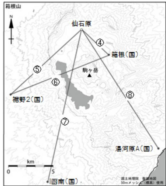
図 2 箱根山 GNSS 連続観測点配置図
