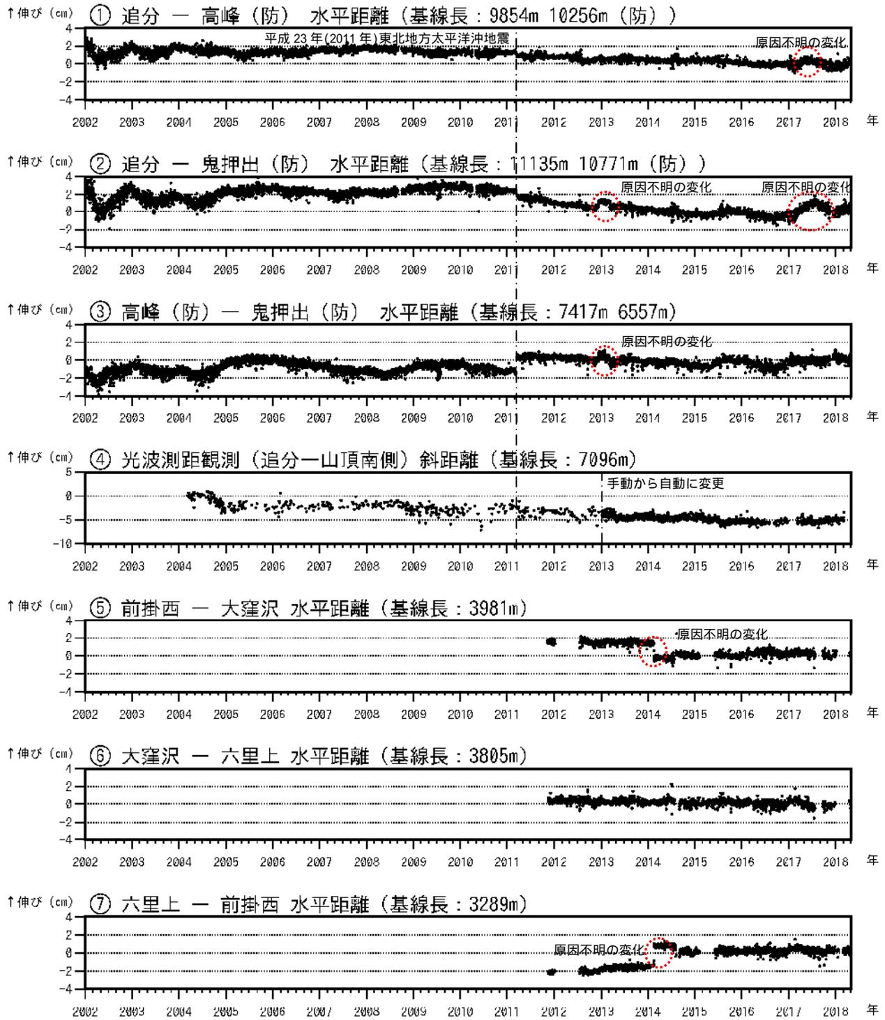
図6 浅間山 GNSS連続観測及び光波測距観測の結果(2002年1月1日~2018年4月30日)
