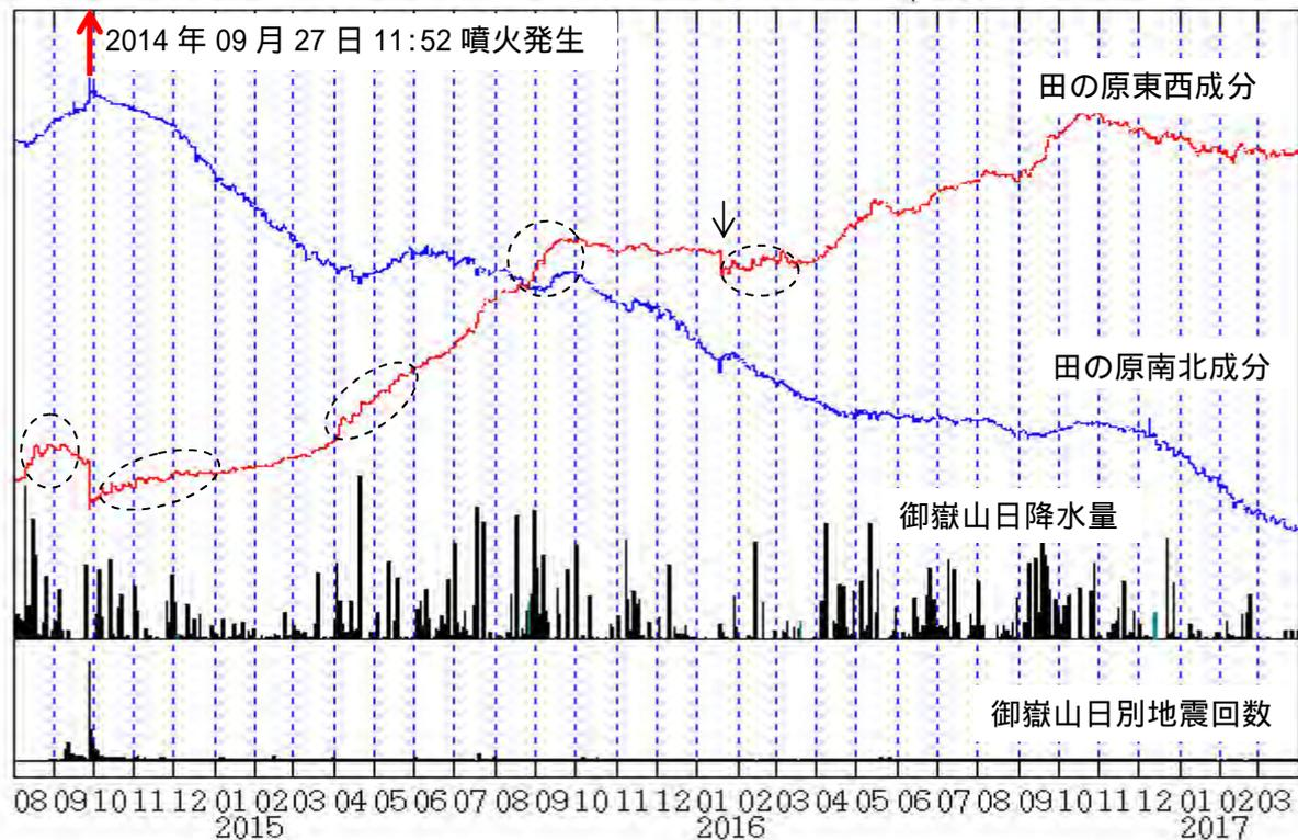
図 6 御嶽山 田の原観測点(剣ヶ峰山頂の南東約 3 km)の傾斜変動
