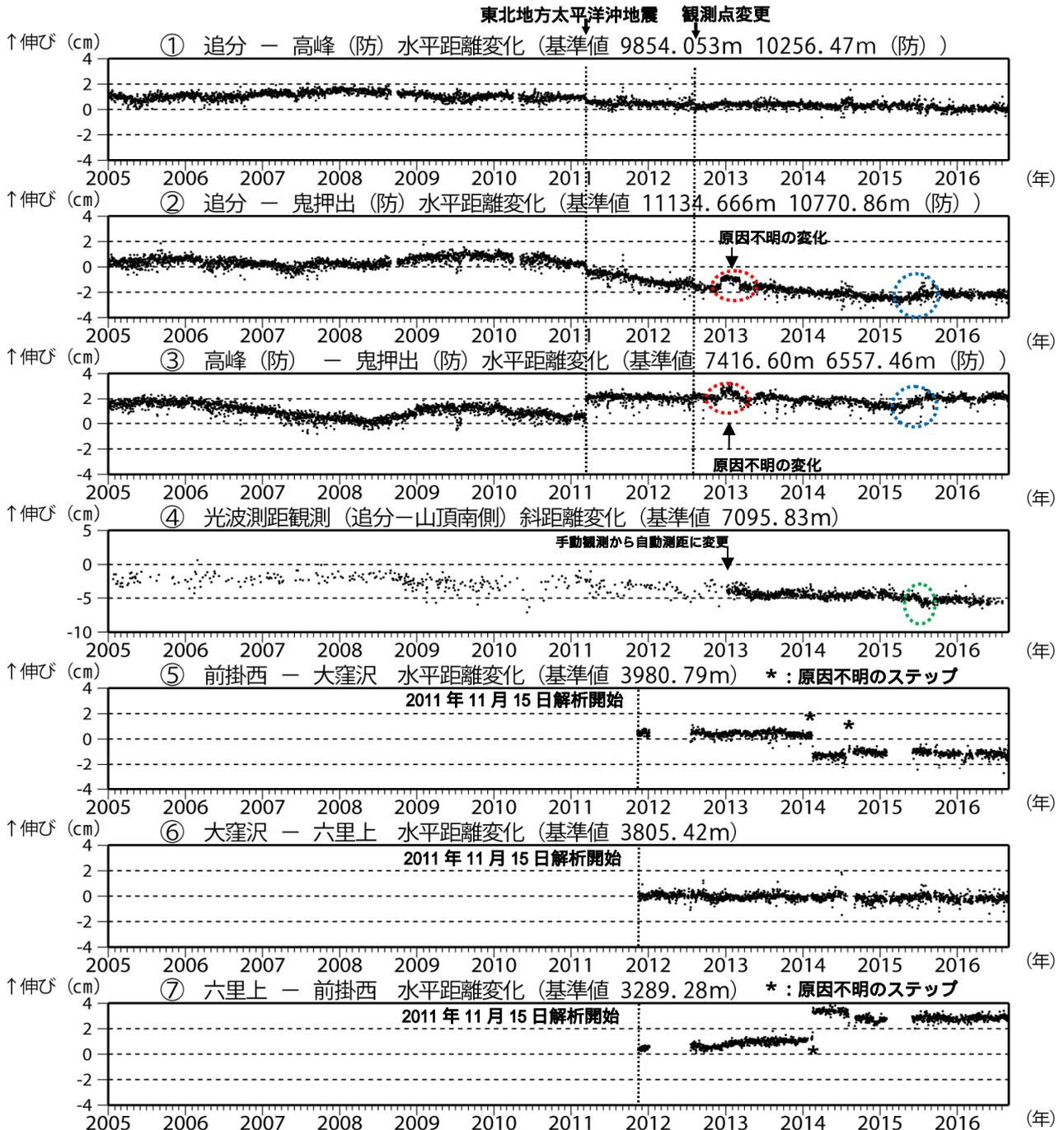
図6 浅間山 GNSS 連続観測及び光波測距観測の結果(2005年1月1日~2016年8月31日)
