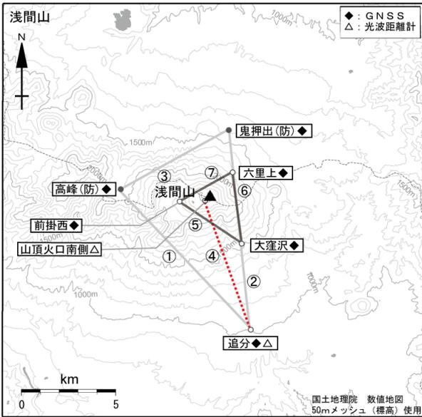
図7 浅間山 GNSS 連続観測点配置図
