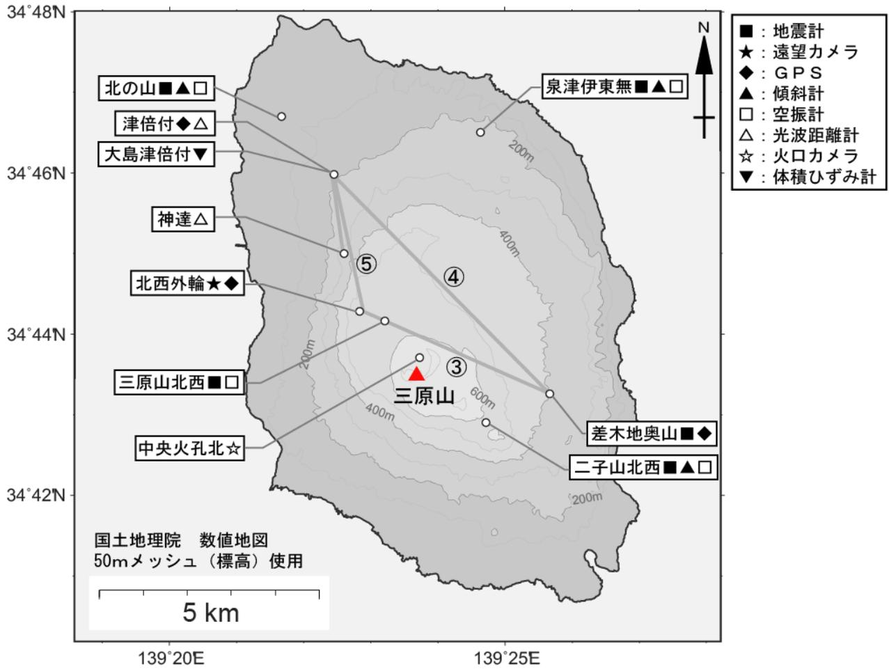
図7 伊豆大島 気象庁の観測点配置図 (小さな白丸は観測点位置を示しています)
