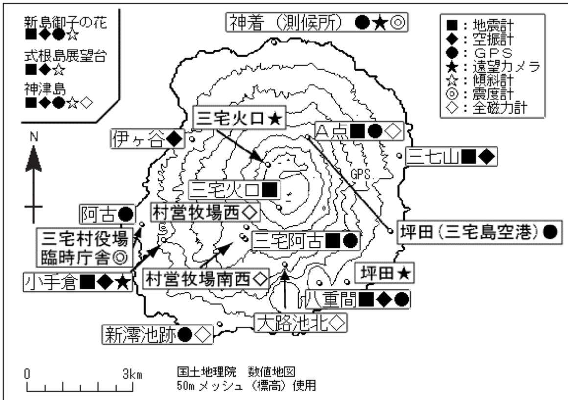
図 8 三宅島 気象庁の観測点配置図（小さな白丸は観測点位置を示しています）
