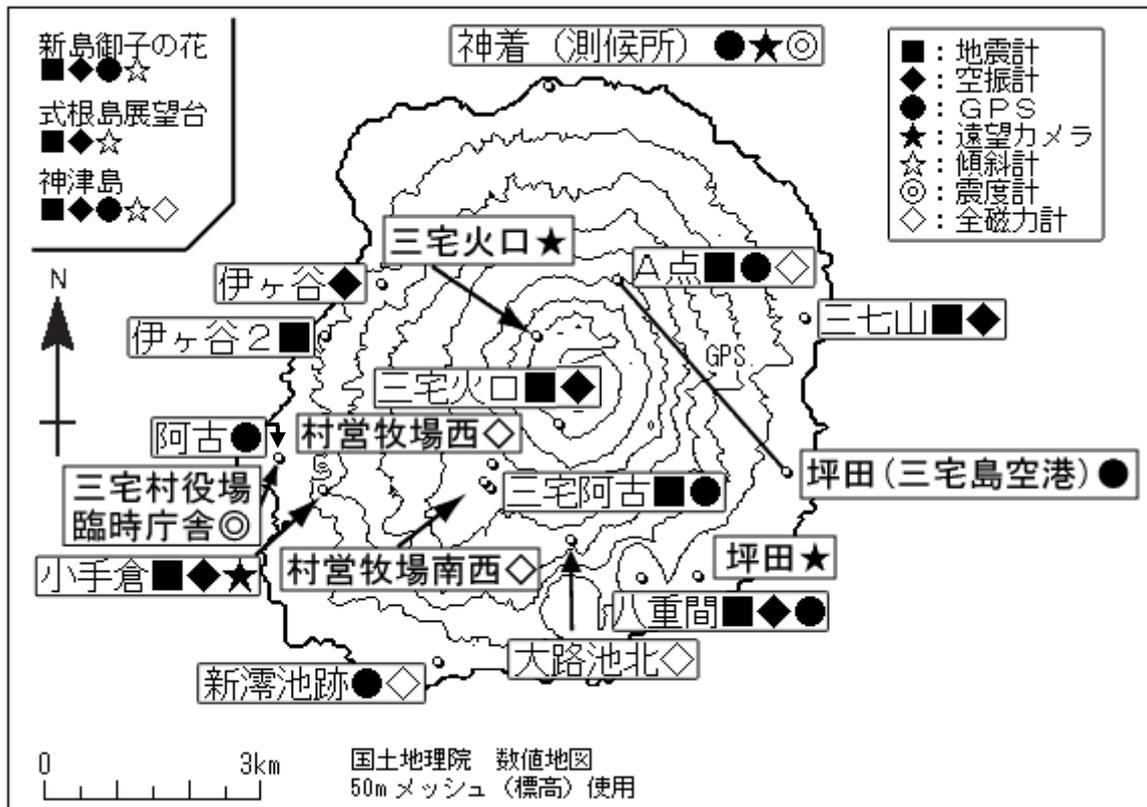
図7 三宅島 気象庁の観測点配置図（小さな白丸は観測点位置を示しています）
