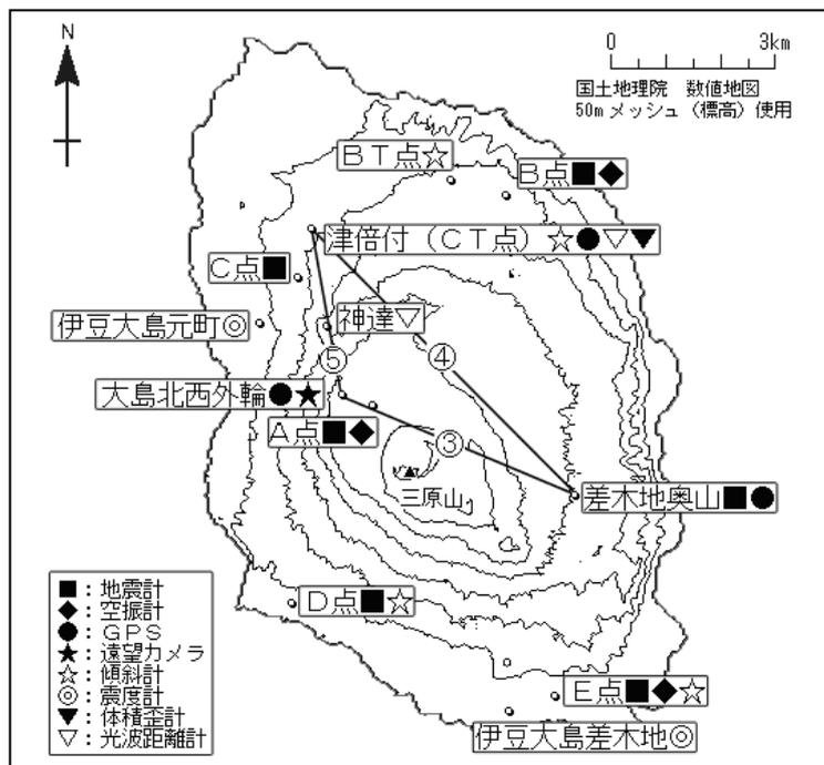
図 7 伊豆大島 気象庁の観測点配置図（小さな白丸は観測点位置を示しています）
