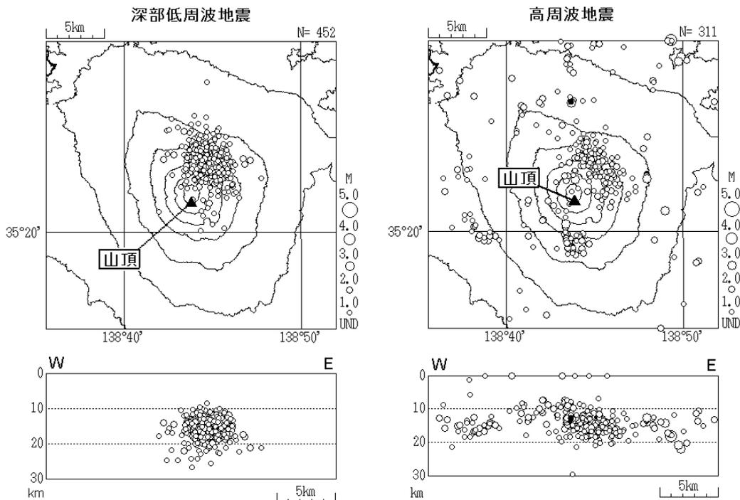
図3※ 富士山 深部低周波地震及び高周波地震の震源分布（上段：震央分布 下段：東西断面）
