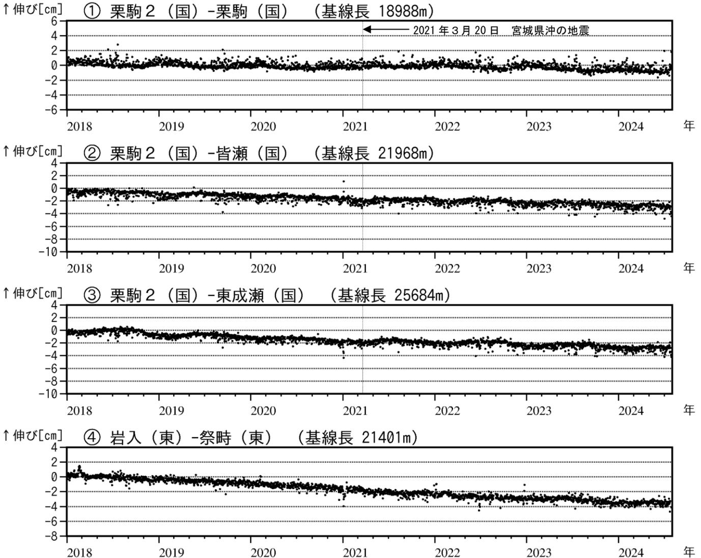
図4 栗駒山 GNSS 基線長変化図（2018年1月～2024年7月）
