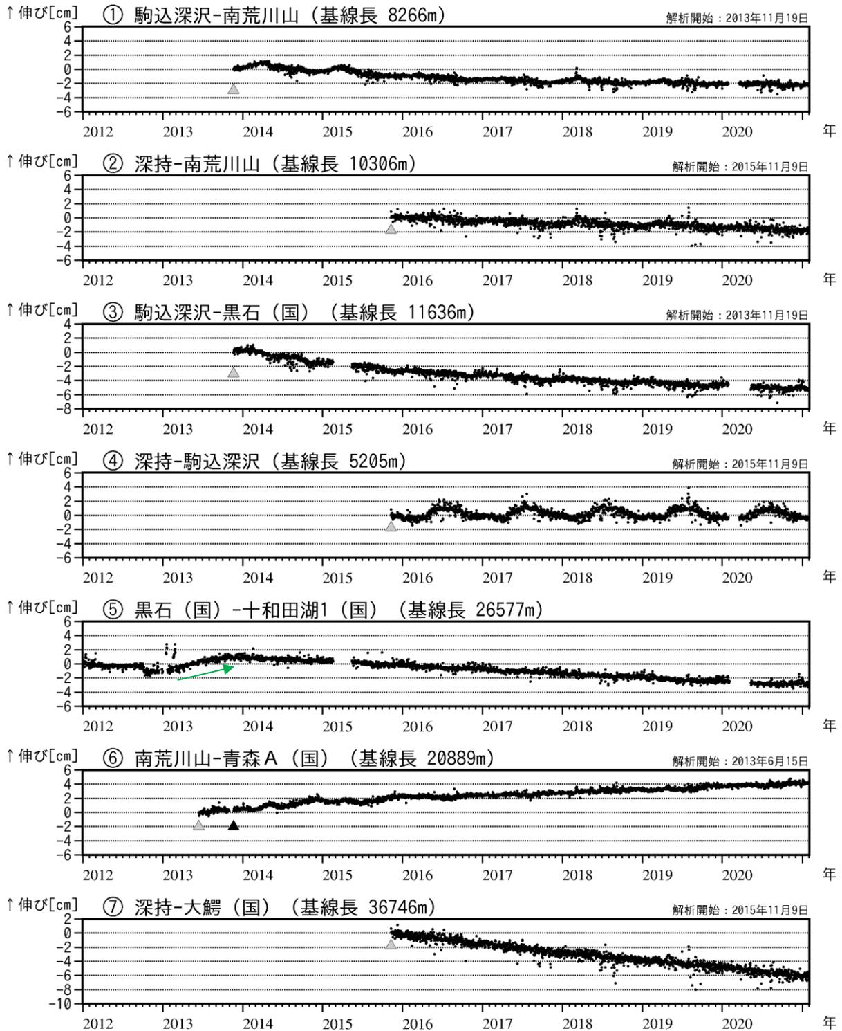
図3 八甲田山 GNSS 基線長変化図（2012年1月～2021年1月）
