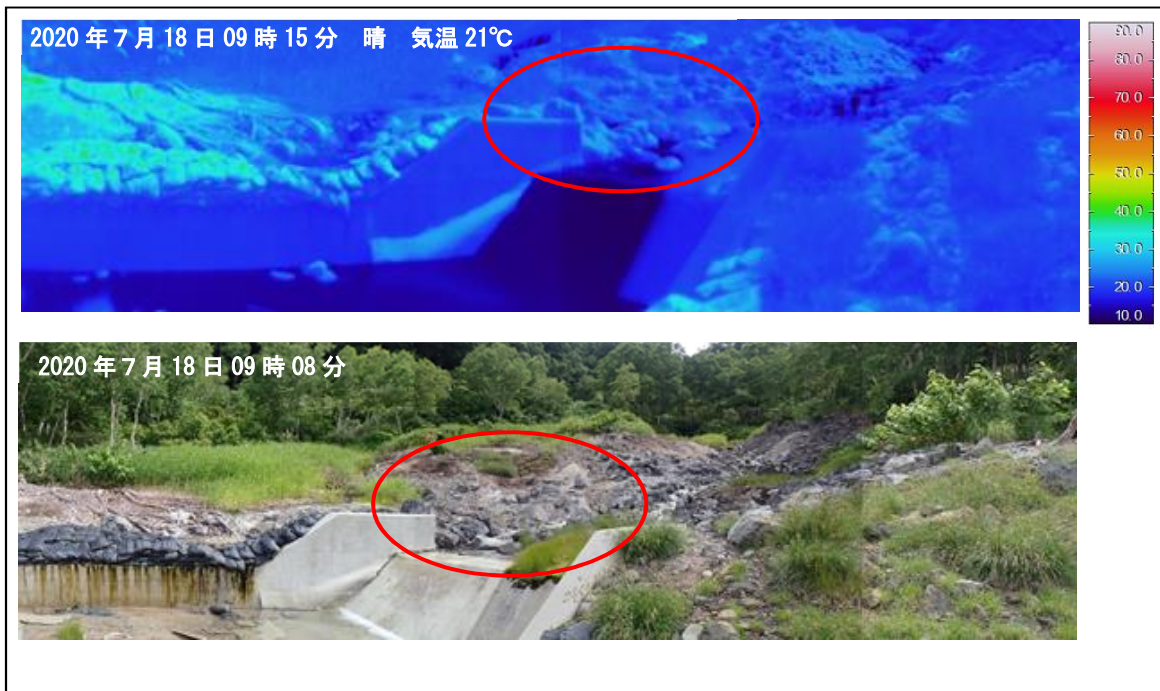
図7 八甲田山 南西方向から撮影した地獄沼東の地熱域の状況と地表面温度分布
