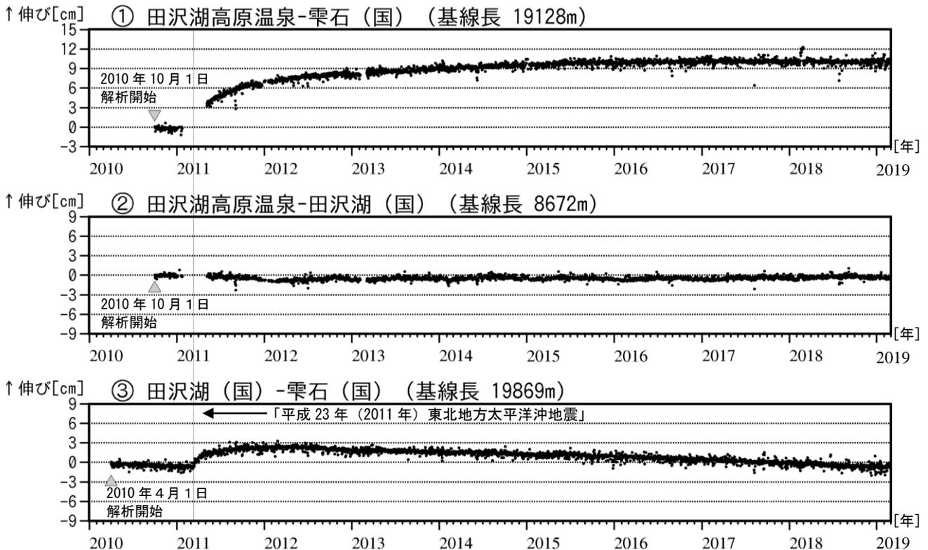
図 7 秋田駒ヶ岳 GNSS 基線長変化図（2010 年 4 月～2019 年 2 月）
