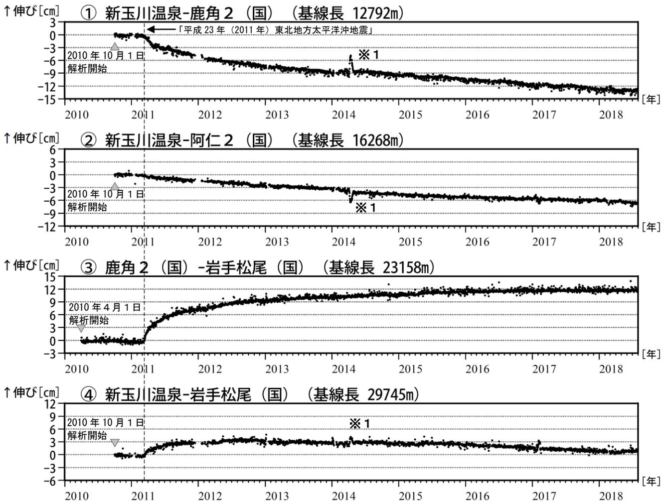
図3 秋田焼山 GNSS<sup>1)</sup> 基線長変化図（2010年4月～2018年7月）
