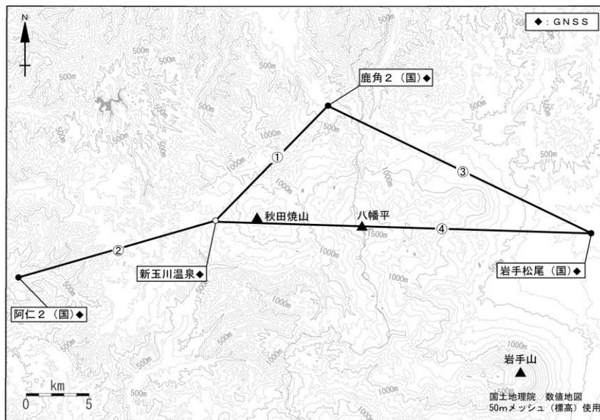
図5 秋田焼山 GNSS 観測基線図
