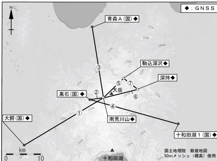
図5 八甲田山 GNSS 観測点配置図
