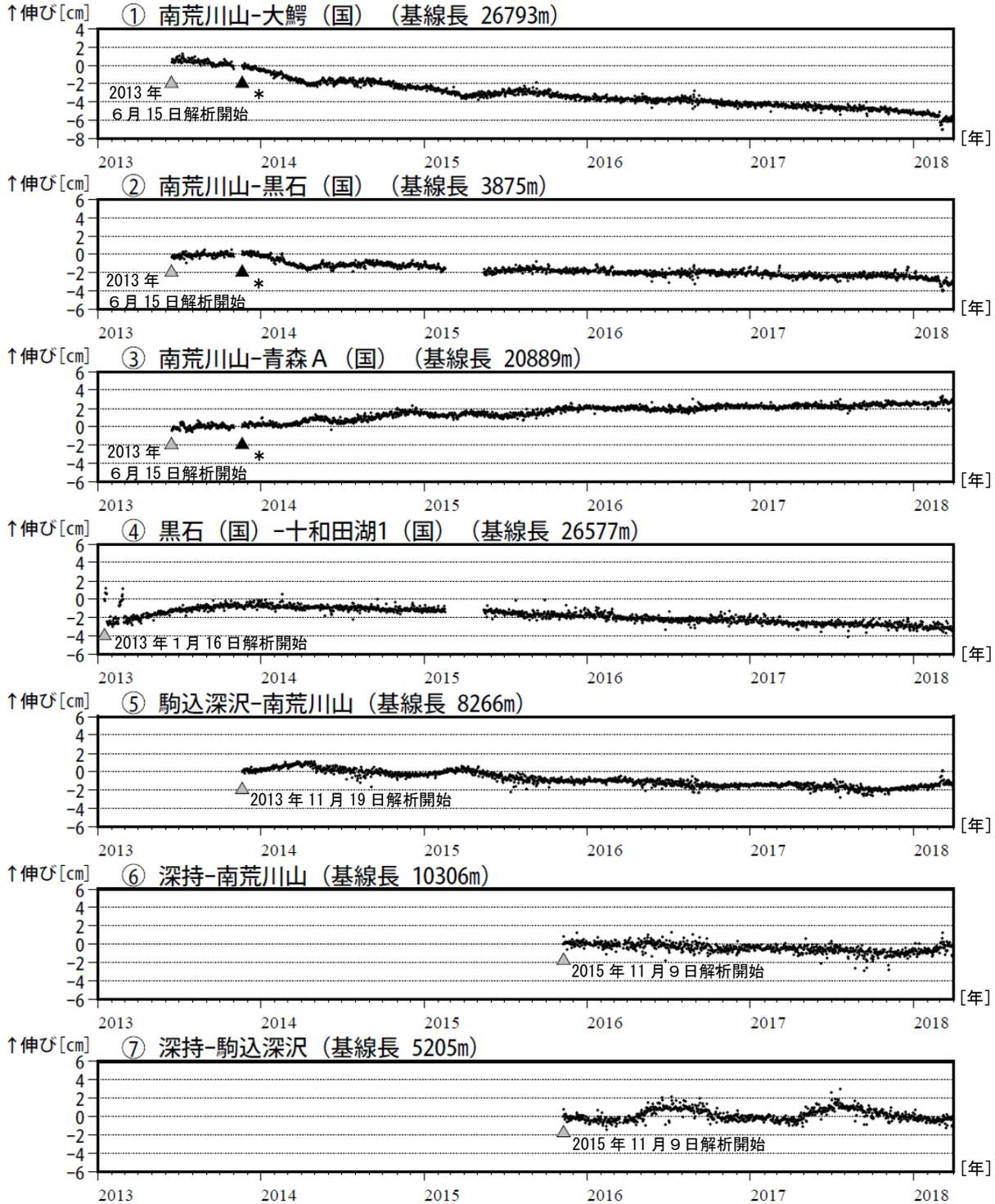
図3 八甲田山 GNSS<sup>1)</sup> 基線長変化図（2013年1月～2018年3月）
