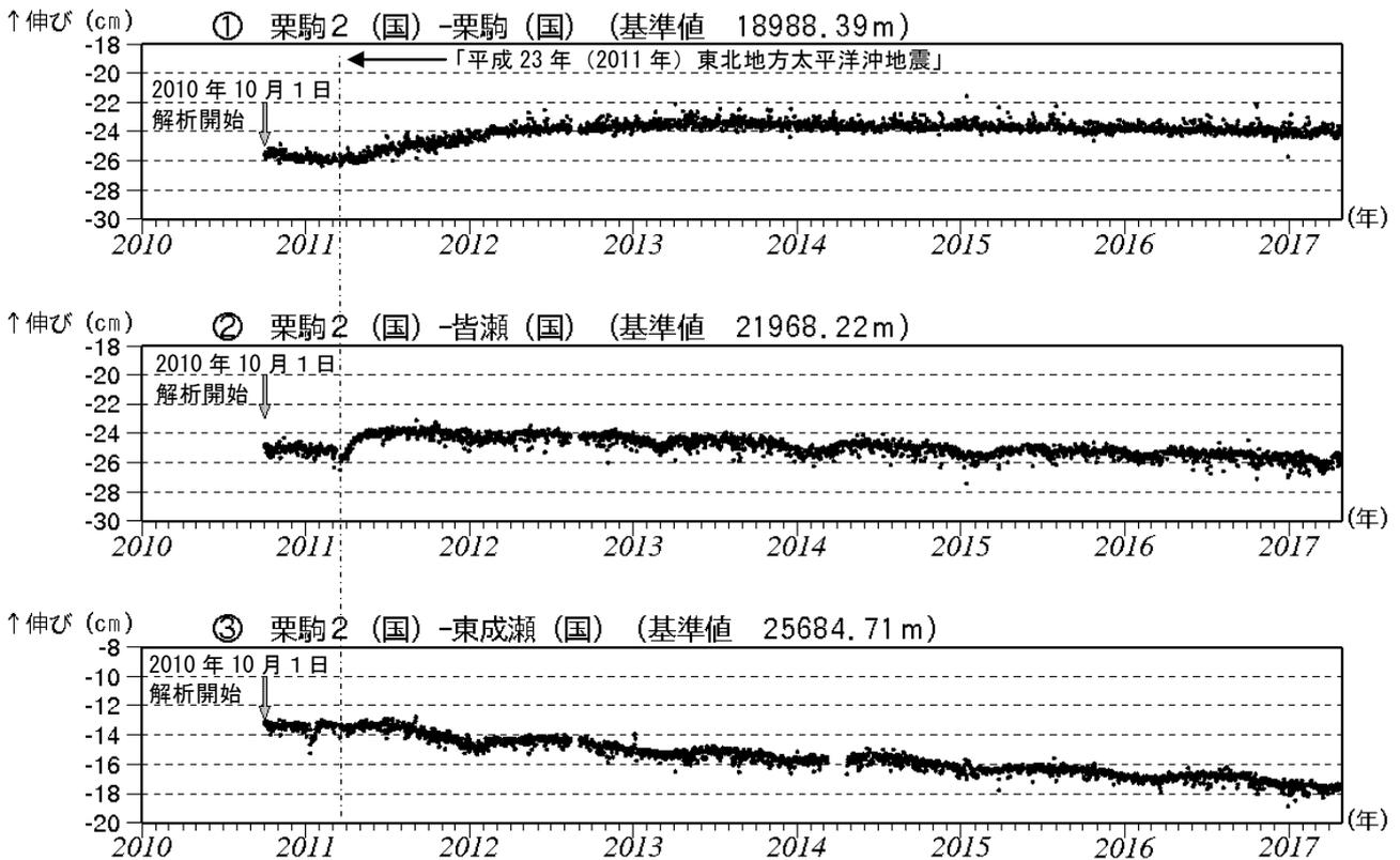
図6 栗駒山 GNSS<sup>1)</sup> 基線長変化図（2010年10月～2017年4月）
