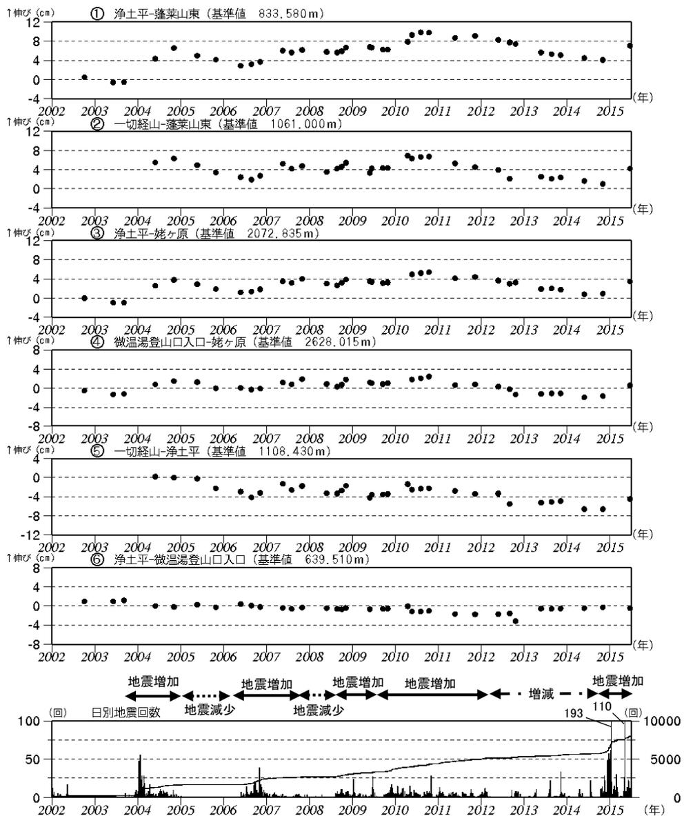
図10 吾妻山 GNSS繰り返し観測による基線長変化図
