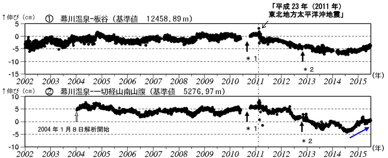
図8-① 吾妻山 GNSS 基線長変化図 (2002 年 1 月～2015 年 6 月)
