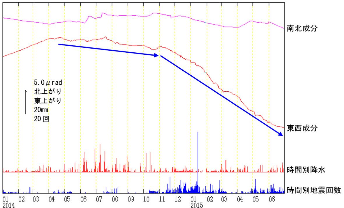
図6 吾妻山 浄土平観測点での傾斜変動
