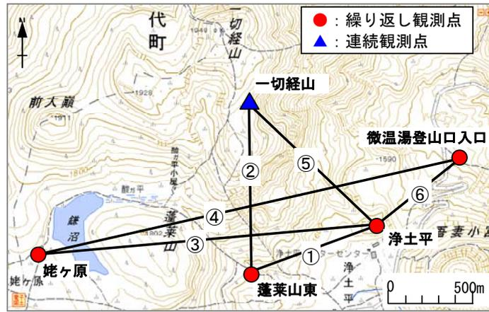
図9 吾妻山 GNSS観測点配置図（繰り返し観測による狭域の観測）
