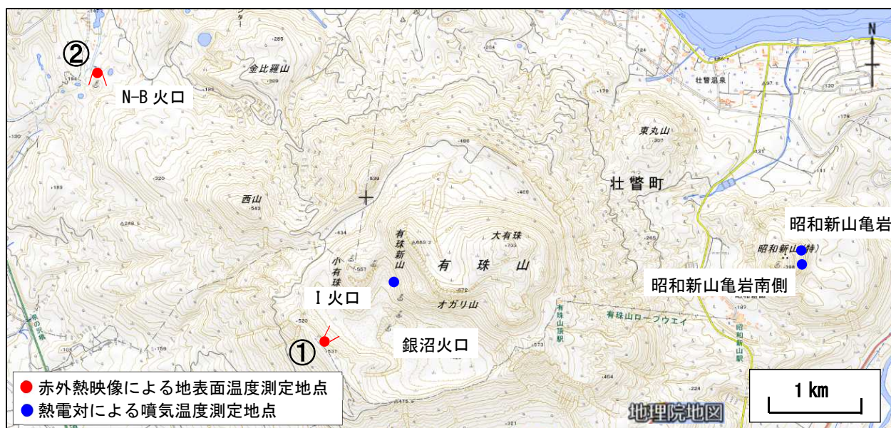
図2 有珠山 周辺図 写真及び赤外熱映像の撮影地点と噴気温度測定地点 赤丸は赤外熱映像撮影地点、2本の直線でおおよその画角を示す 青丸は噴気温度測定地点
