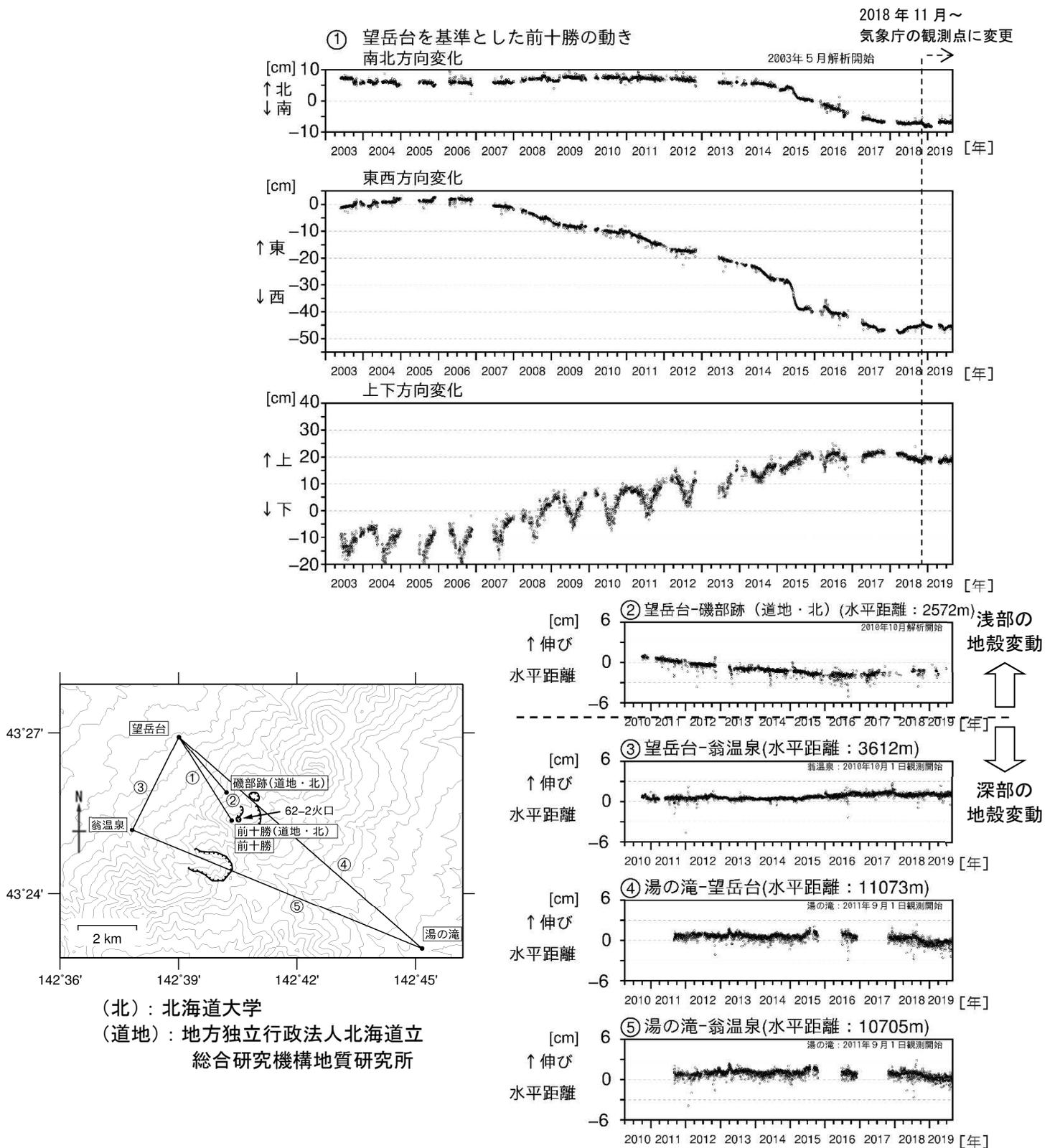
図5 十勝岳 GNSS連続観測による水平距離及び上下変化(2003年5月~2019年8月)及び観測点配置図
