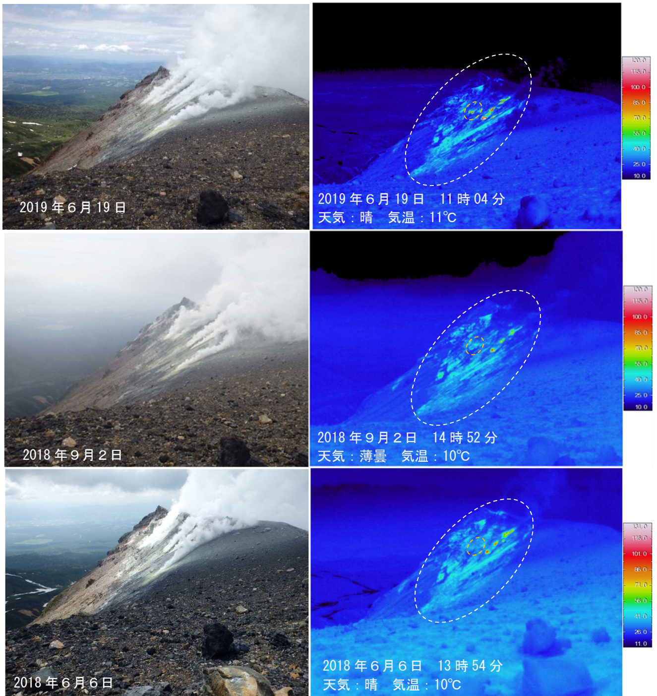
図5 十勝岳 赤外熱映像装置による振子沢噴気孔群の地表面温度分布 南東側（図3の②）から撮影
