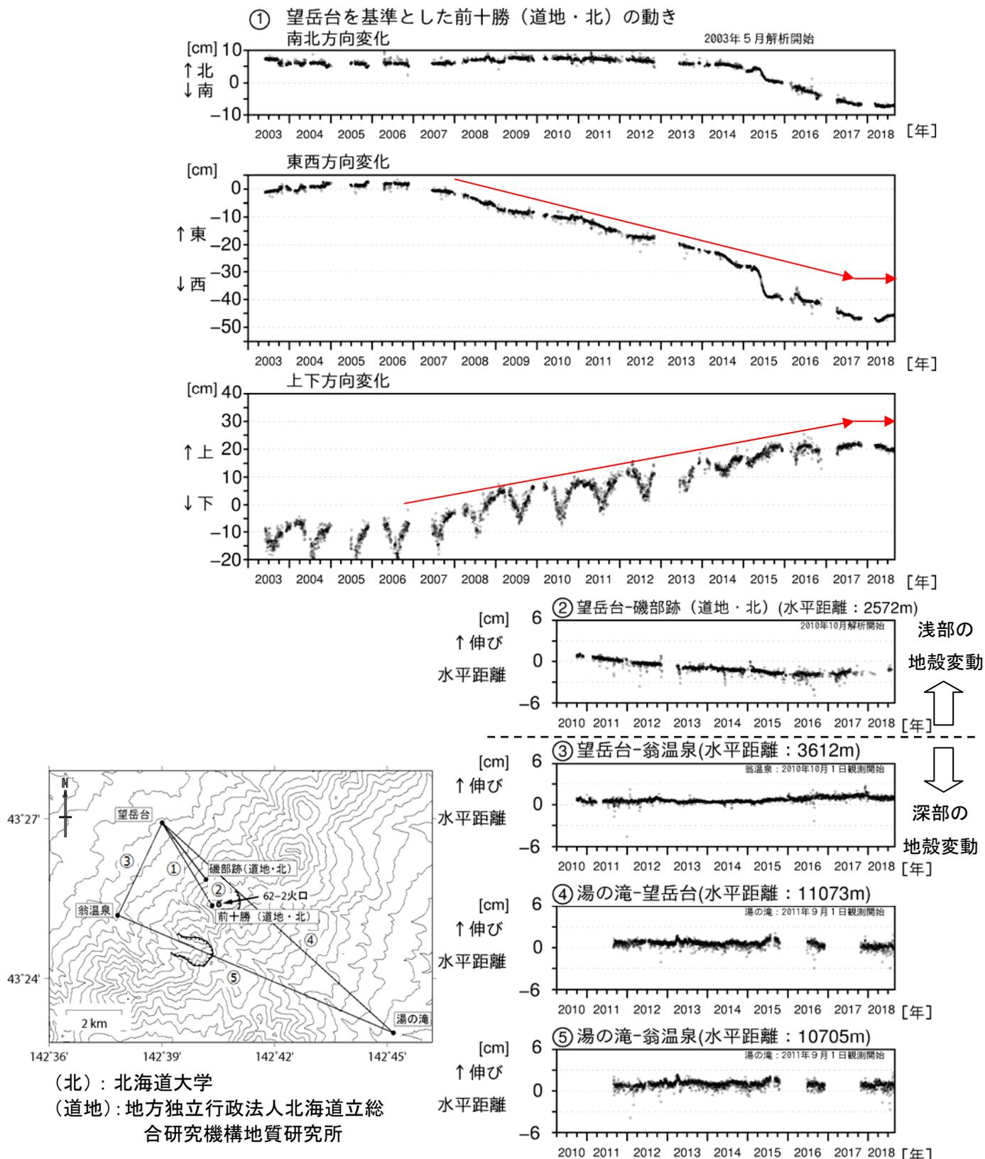
図6 十勝岳 GNSS連続観測による水平距離及び上下変化（2003年5月～2018年8月）と観測点配置図
