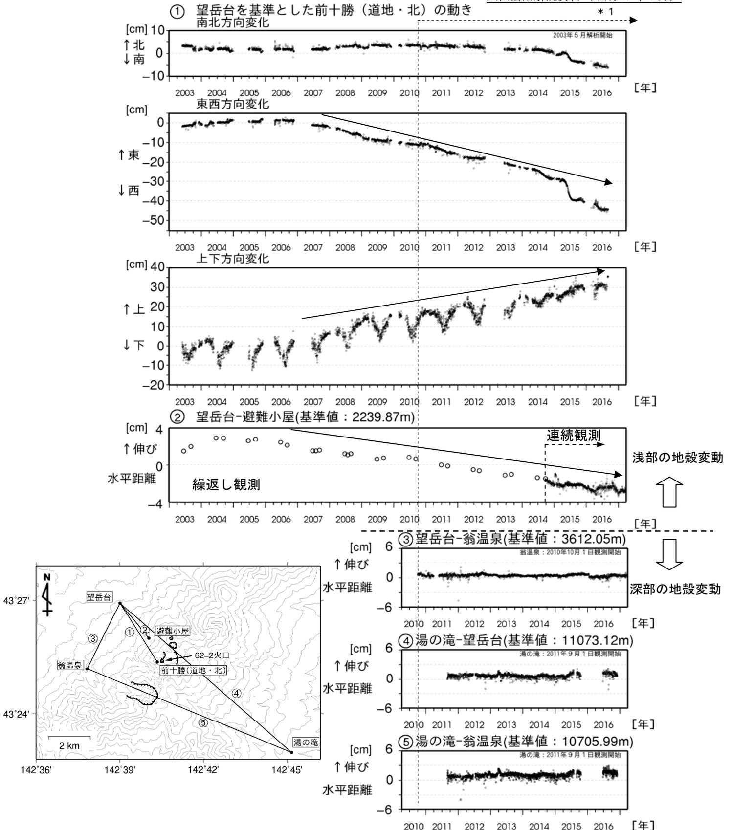
図 6 十勝岳 GNSS連続観測による水平距離変化（2003年5月～2017年3月）及び観測点配置図
