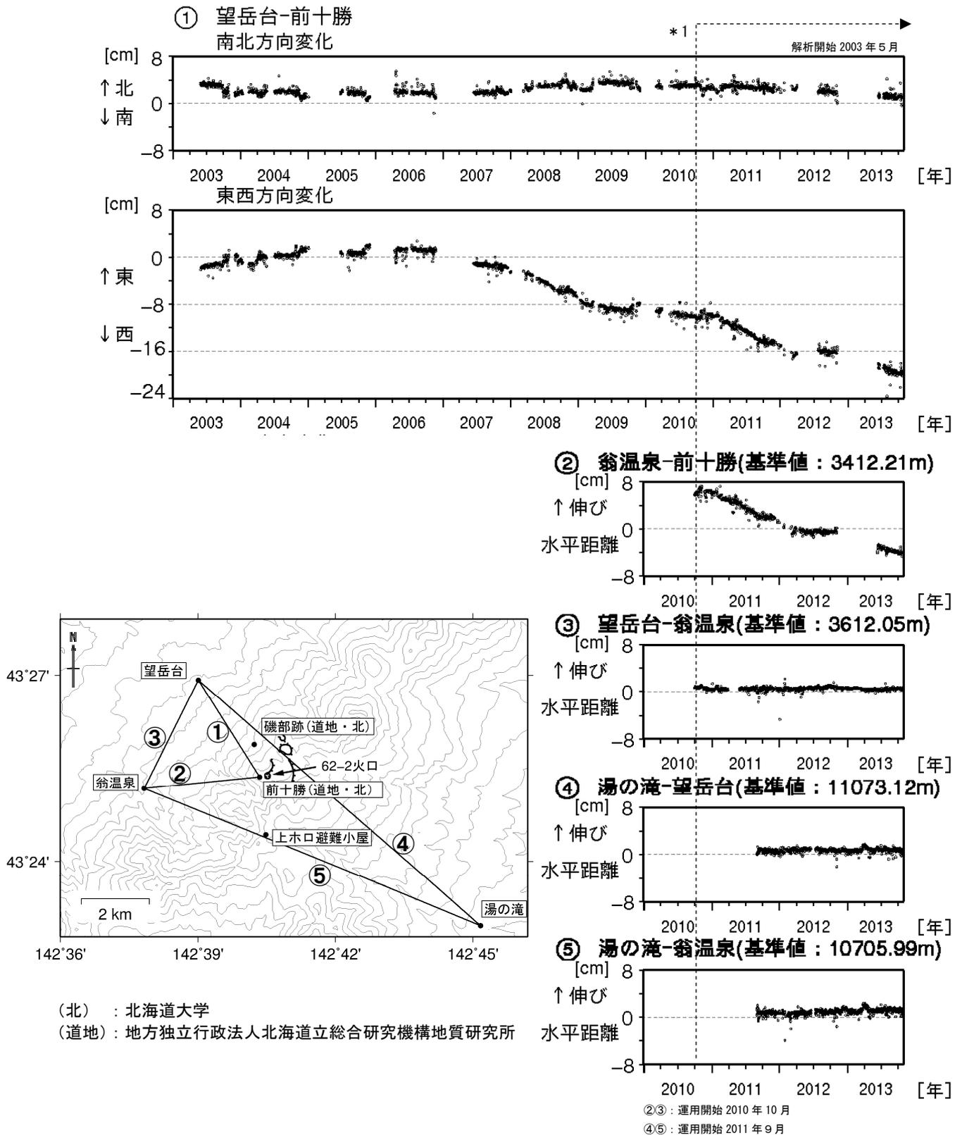
図4 十勝岳 GPS連続観測による基線長変化(2003年5月~2013年10月)及び観測点配置図
