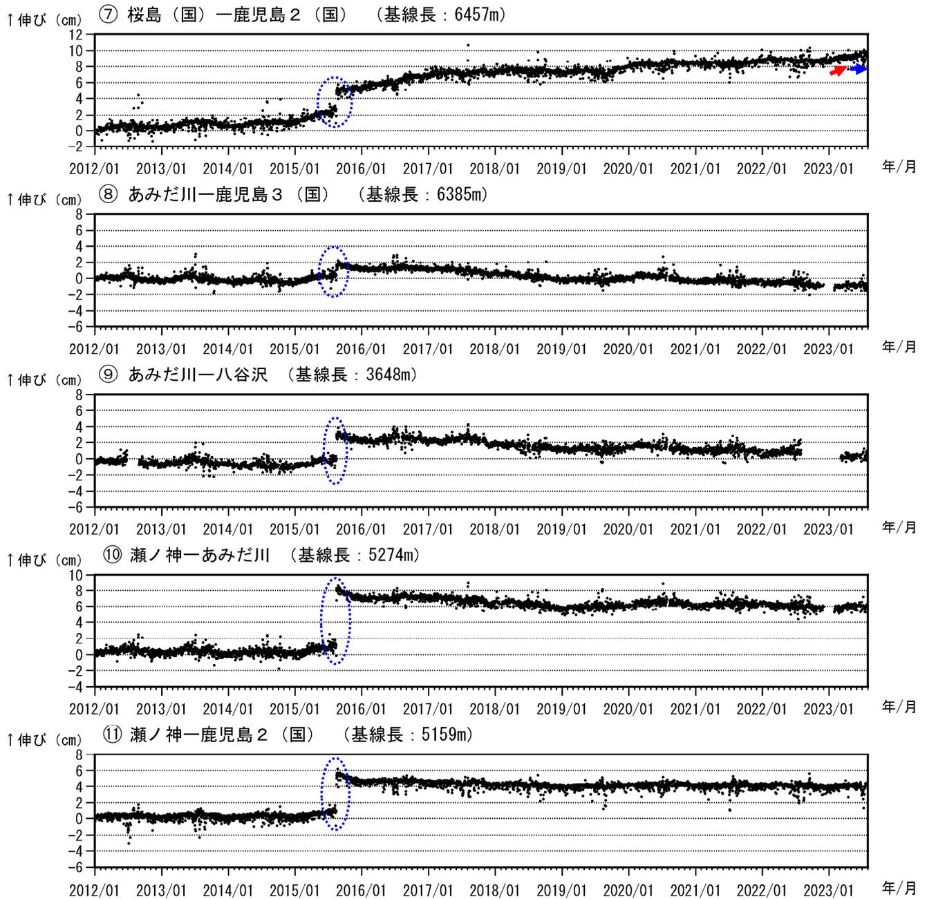
図 8-2 桜島 GNSS 連続観測による基線長変化 (2012 年 1 月～2023 年 7 月)
