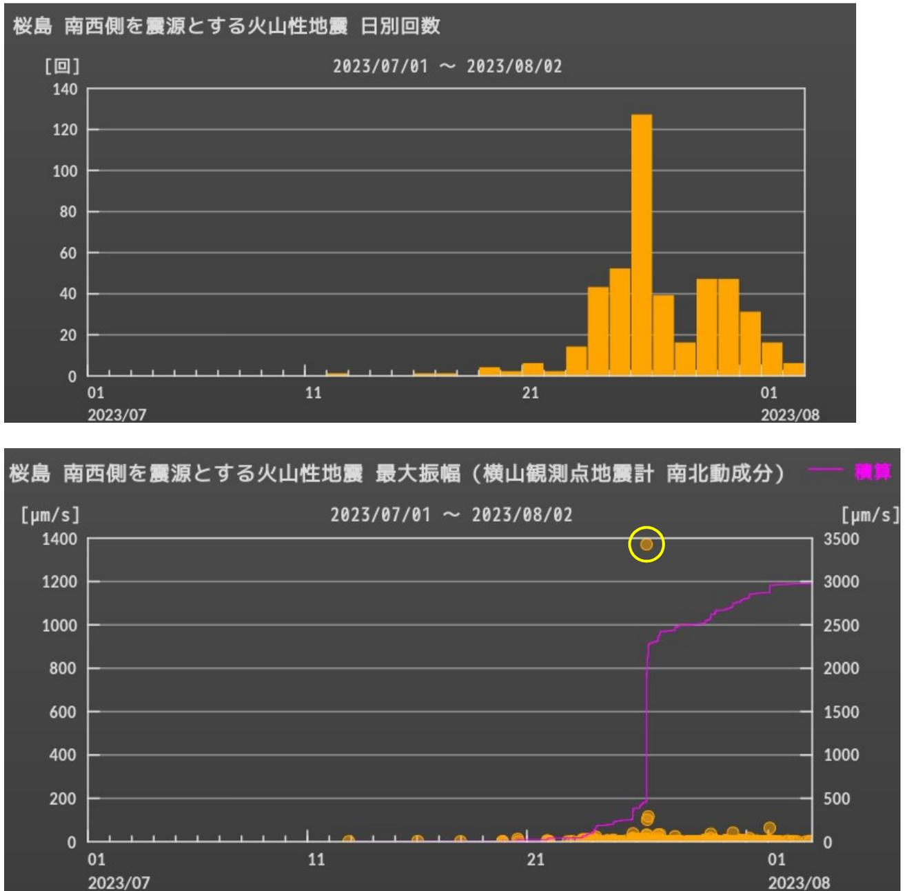
図3 桜島 南西側を震源とする火山性地震の日別回数及び最大振幅(横山観測点地震計 南北動成分) (2023年7月～8月2日(期間外))
