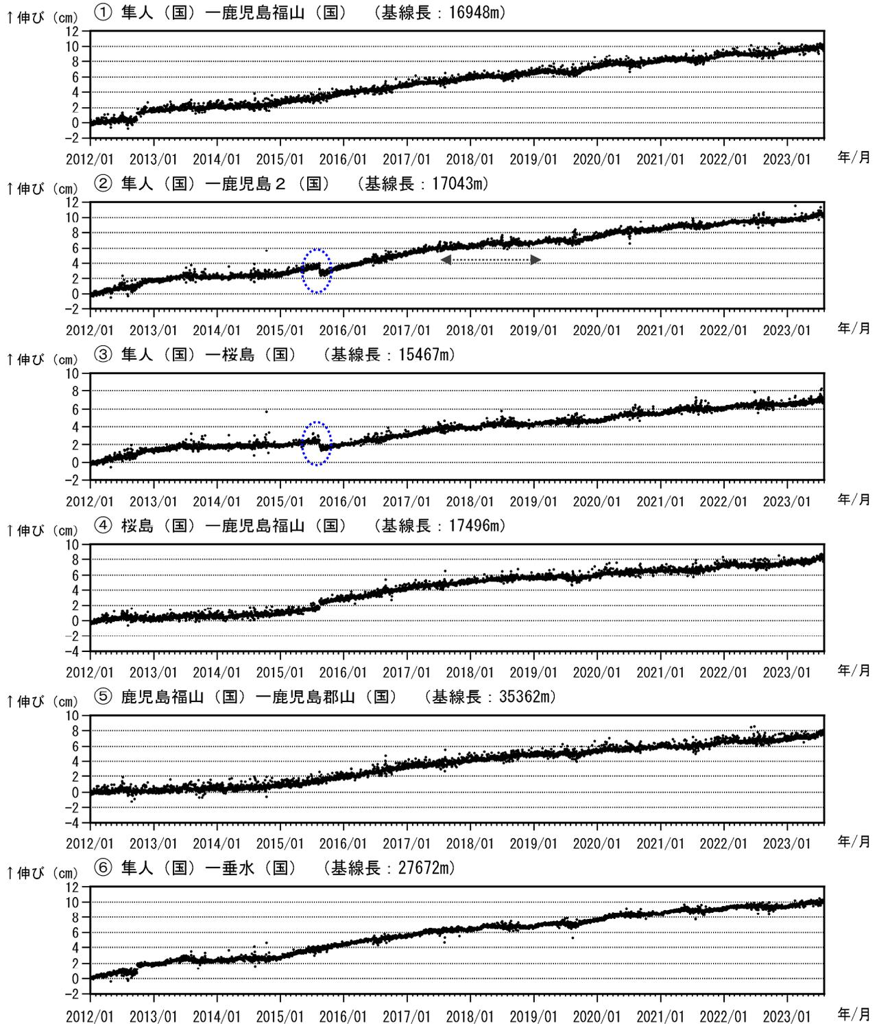
図 8-1 桜島 GNSS 連続観測による基線長変化（2012 年 1 月～2023 年 7 月）
