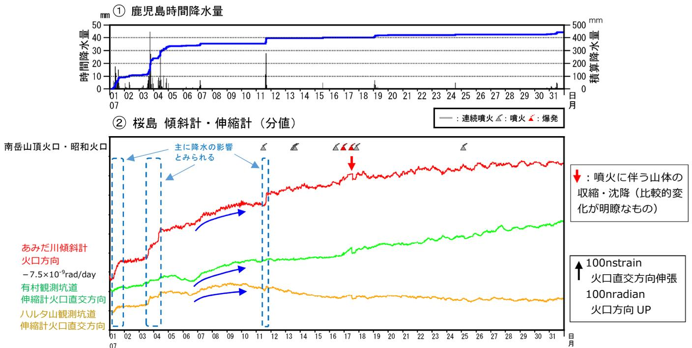
図7 桜島 傾斜計及び伸縮計による地殻変動の状況（2023年7月）
