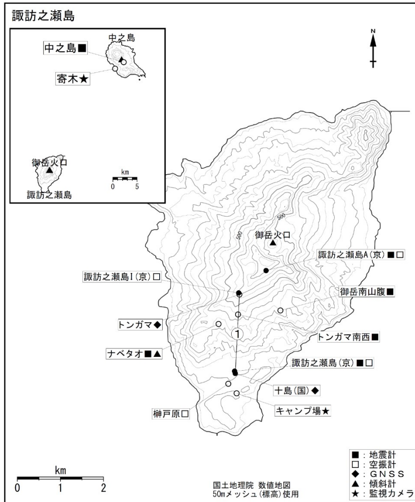
図9 諏訪之瀬島 観測点配置図とGNSS連続観測による基線番号
