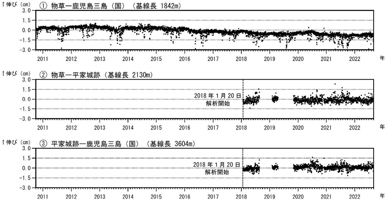
図6 薩摩硫黄島 GNSS連続観測による基線長変化 (2010年10月～2022年8月)
