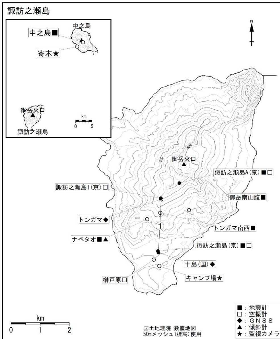
図5 諏訪之瀬島 観測点配置図とGNSS連続観測による基線番号
