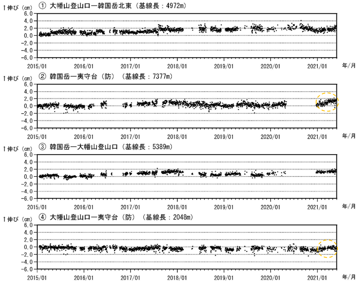
図4 霧島山（大幡池） GNSS 連続観測による基線長変化（2015年1月～2021年5月）
