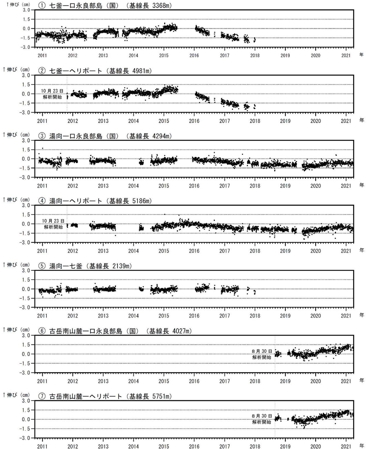
図 11 口永良部島 GNSS 連続観測による基線長変化（2010 年 10 月～2021 年 3 月）
