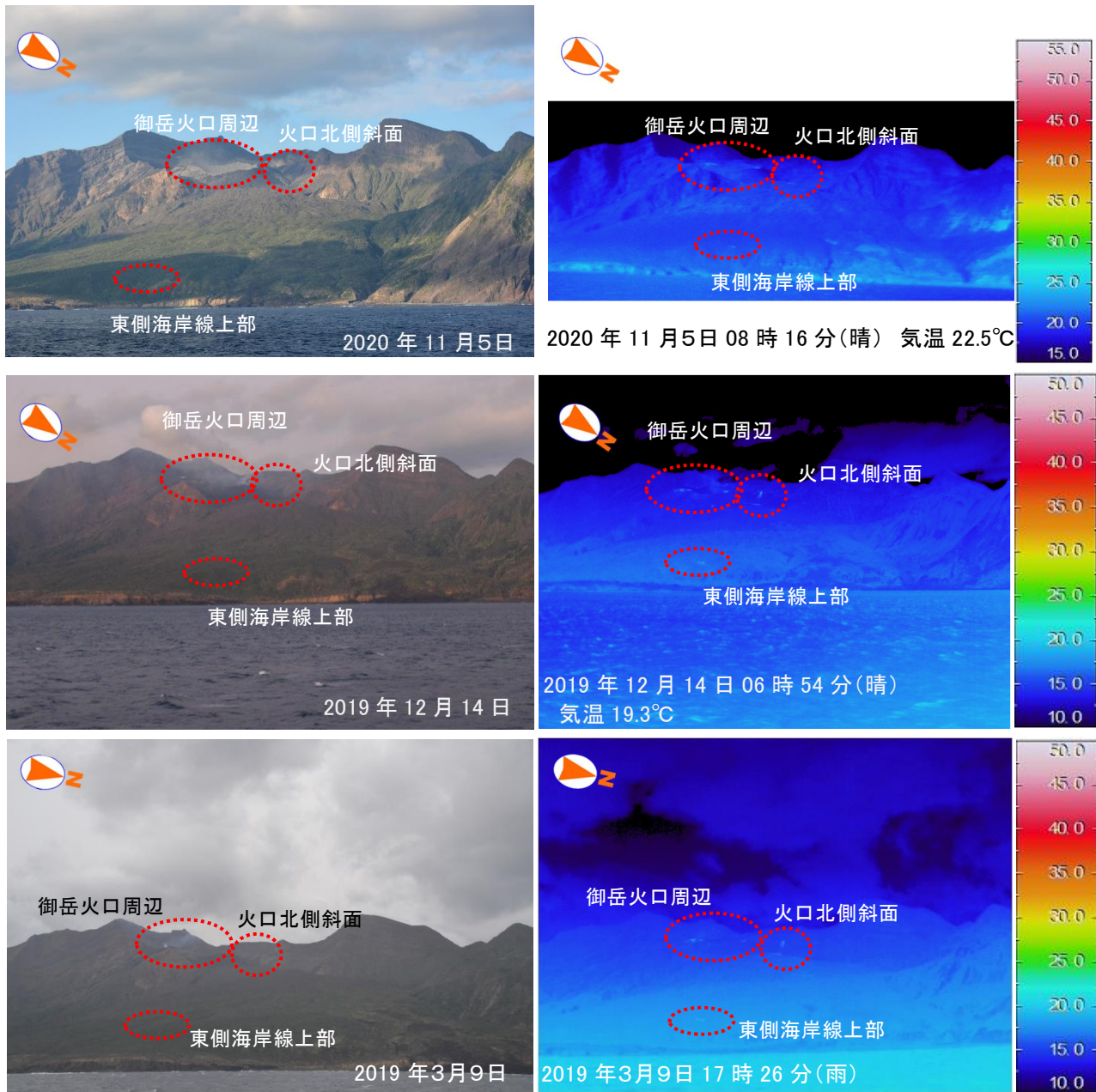
図 3-1 諏訪之瀬島 諏訪之瀬島東側斜面の地表面温度分布（5日、東方沖より撮影）
