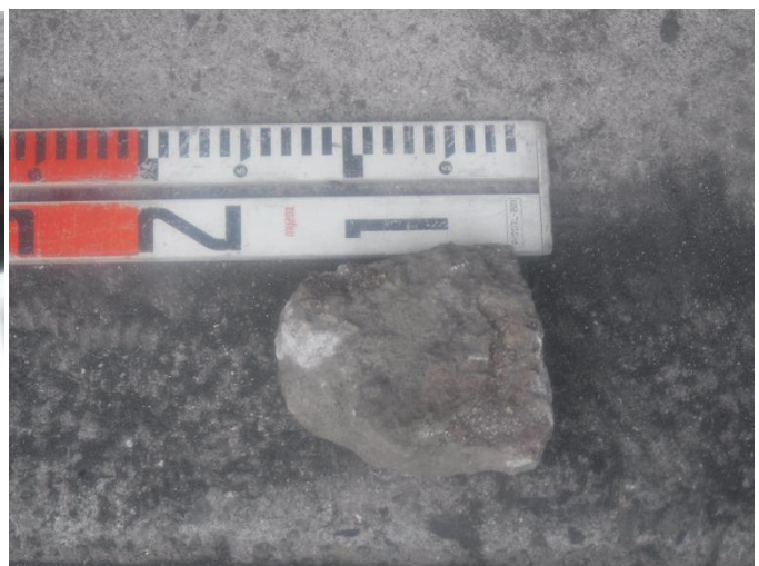
図 1-3 桜島 落下痕の近傍の建物で確認した屋根の被害状況及びその被害をもたらした岩石（写真提供：鹿児島市）
