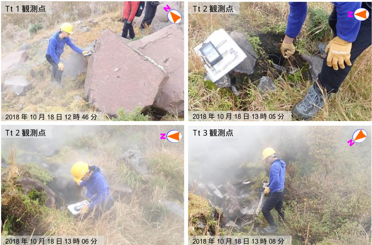
図 6 雲仙岳 立岩の峰噴気地帯のサーミスタ温度計による測定状況 (Tt 1 ~ 3 における観測)
