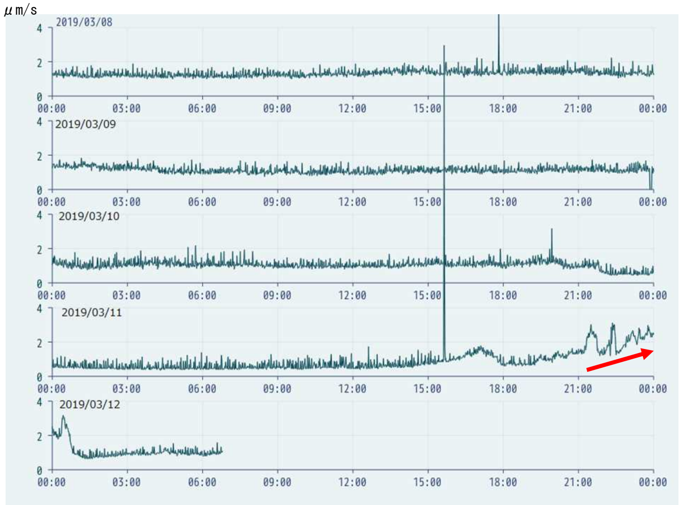
図2 阿蘇山 火山性微動1分間平均振幅 (中岳西山腹観測点南北成分、3月8日～3月12日07時頃)
