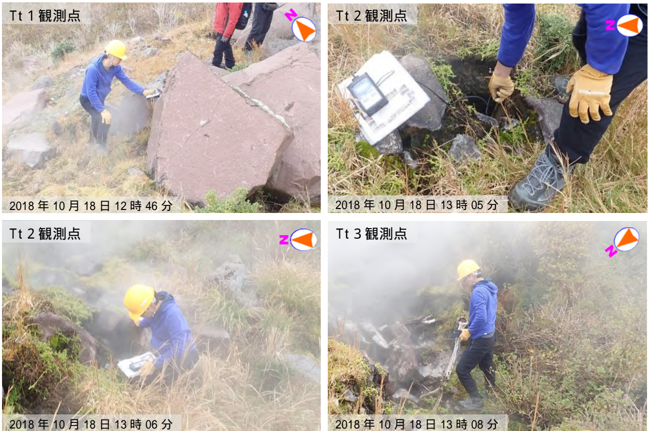
図6 雲仙岳 立岩の峰噴気地帯のサーミスタ温度計による測定状況(Tt 1 ~ 3における観測) 立岩の峰噴気地帯の噴気温度は52~64 と前回(2017年12月14日:38~67 )と比較して特 段の変化は認められませんでした。
